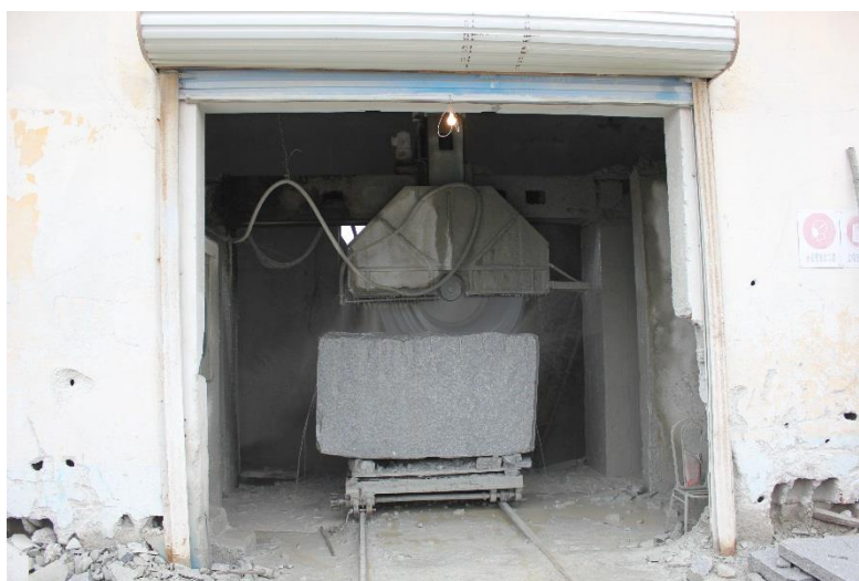
Blocksågning till ämnesskivor 80 mm, bild 0210
