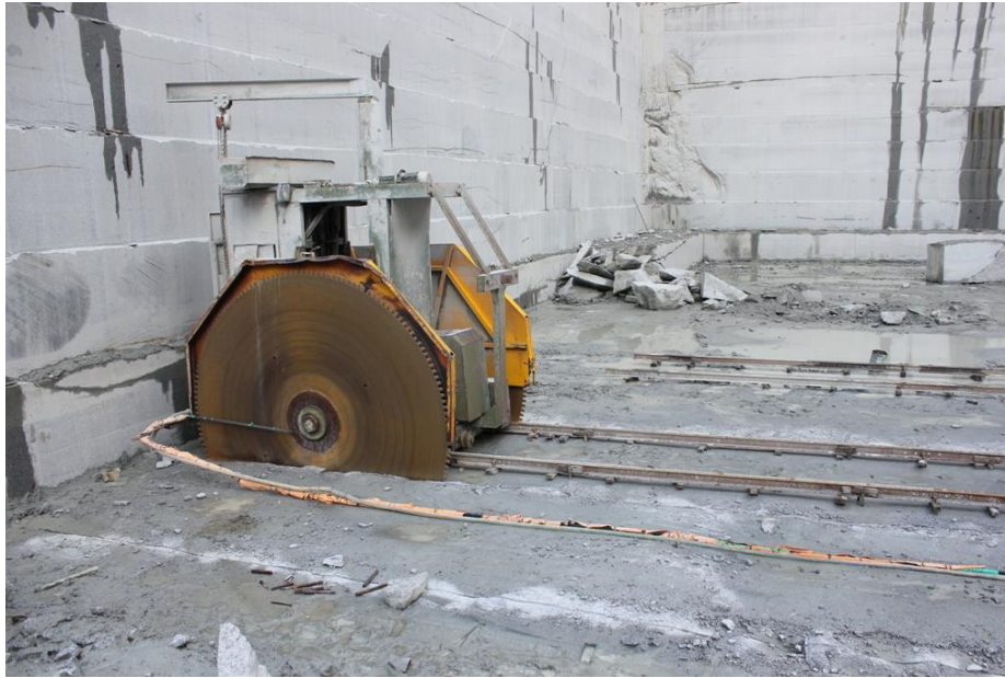
Sågning av vertikala snitt.
