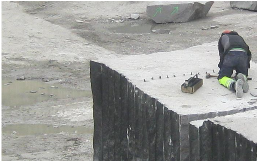
Nedkilning av primärblock med borrar och kilning
