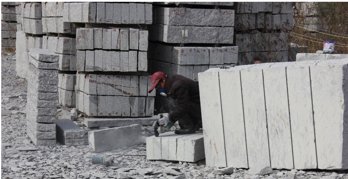
Bild 3092. Sågning av spår för klyvning.
