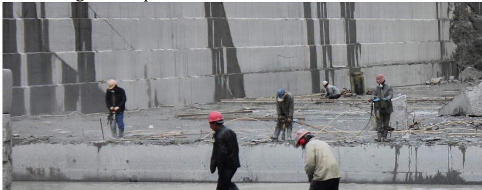
Bild 5998 Delning med borring och kilning vertikal delning.
