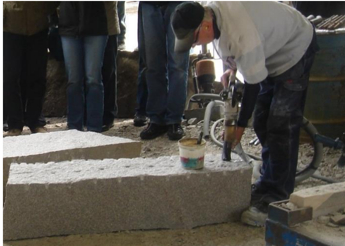
Borrning av kilhål
