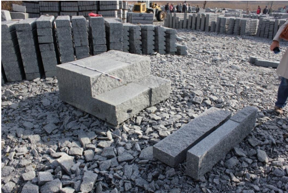
Blocken delas upp genom sågning och borring kilning
