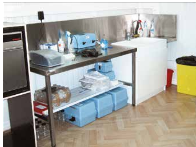
Figure 3 : Laboratoire d'analyses d'eau de l'armée française au Liban. Le principe retenu est de disposer sur le terrain de matériels de base pour réaliser des analyses de routine, portant principalement sur des paramètres bactériologiques et physico-chimiques. Ce type de laboratoire est doté d'étuves pour bactériologie, d'un turbidimètre, d'un chloromètre, d'un conductimètre-pHmètre, et d'un spectrophotomètre.
