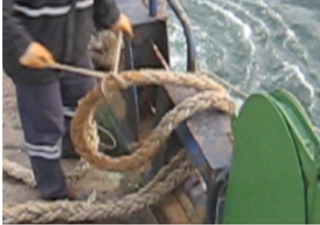
Şekil 3.11: Bir ucu puntele bağlanan el incesinin diğer ucunun halatın kasasına foralı çifte kazık bağı ile bağlanması
