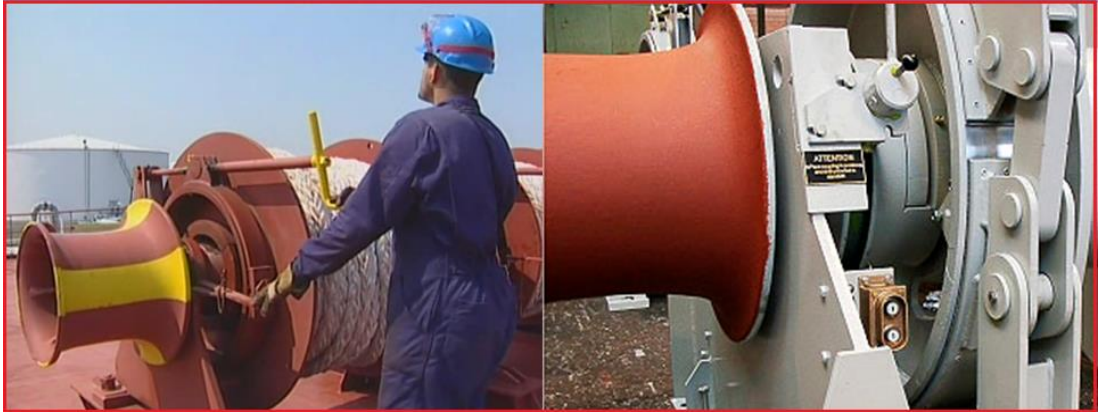
Şekil 2.25: Irgatın fenerliği döndürmesi (dişli yerine oturmuş)
