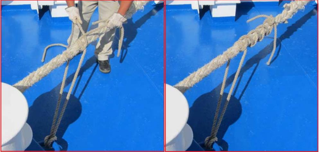
Şekil 3.20: Çift kol ile barbarişka bağı ile bosalama
