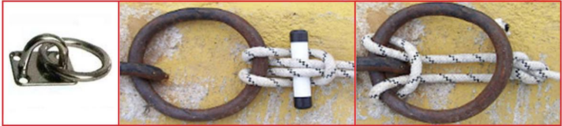
Şekil 4.23: Halatın kasası , mapa veya benzer unsurlara geçirilerek bir kavela yardımı ile veya içten geçirme ile sabitlenebileceği
