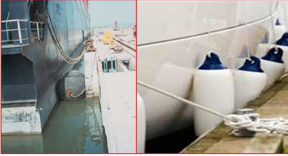
Şekil 5.3: Usturmaçalar iskele veya komşu tekne yüksekliğine göre ayarlanabileceği
