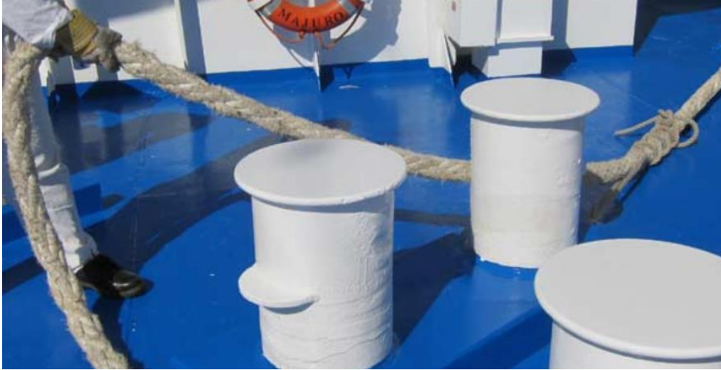
Şekil 3.25: Halatın voltasına başlanması
