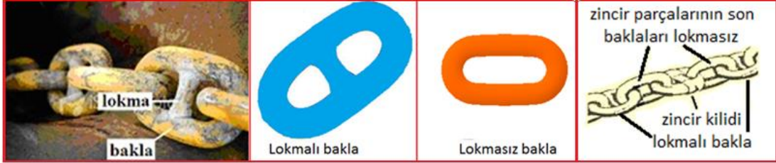
Şekil 2.6: Zincirin lokmalı ve lokmasız görünüşleri
