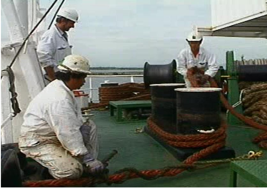
Şekil 4.19: Sentetik halatlar için voltadan önce 2 tur atılmasının daha güzel olacağı
