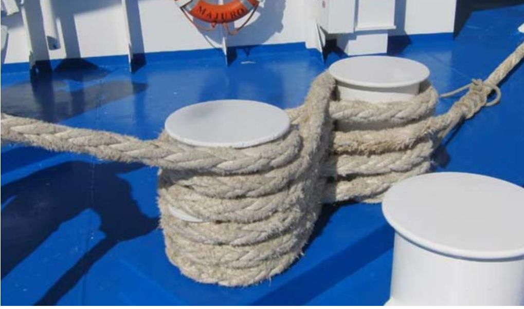
Şekil 4.20: Halatın volta edilmiş durumu mezavolta yapılmamış
