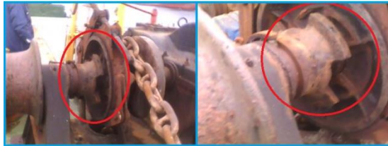
Şekil 2.26: Bu pozisyonda ırgatın fenerliği döndüremeyeceği
