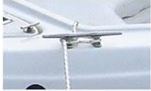
Şekil 4.22: Koçboynuzuna voltanın da aynı çift babaya volta gibi yapılacağı
