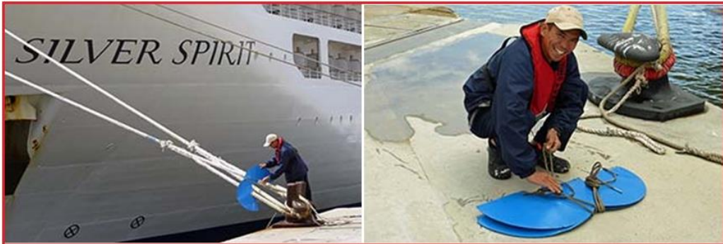
Şekil 5.23: Bağlama işlemi tamamlandıktan sonra yanaşılan limanlardan gemiye fare gelmemesi için bağlama halatlarına fareliklerin takılmasının gerekliliği
