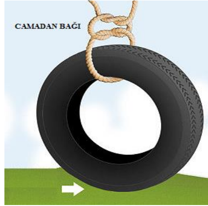
Şekil 5.20: Zor durumda kaldığımızda kendi usturmaçanızın yapılabileceği
