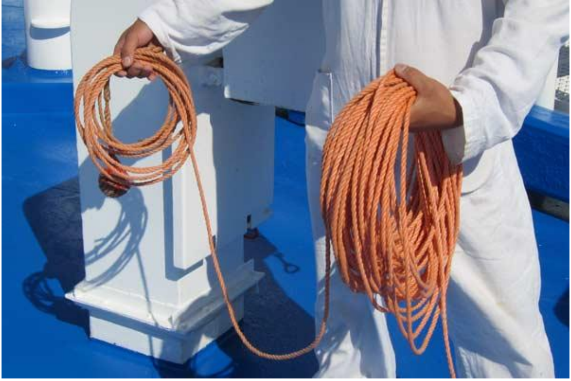
Şekil 3.3: Hazırlanmış bir el incesi
