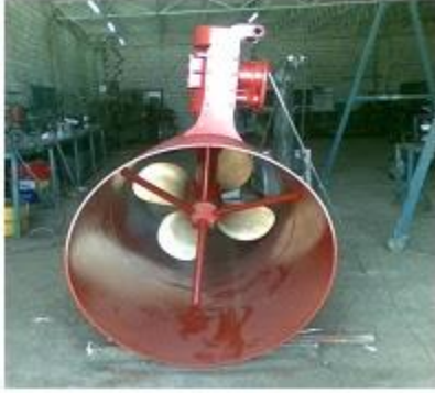
Şekil 1.17: Geminin baş veya kıç tarafına konan iterler ile de döndürülebileceği
