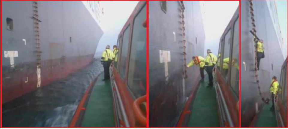
Şekil 5.28: Fazla uzun bir pilot çarmıhı
