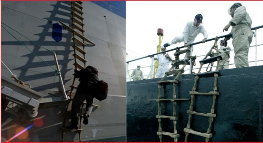
Şekil 5.25: Pilot çarmıhlarının farklı uzunluklarda olabileceği
