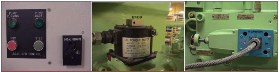
Şekil 1.13: Dümen sistemi çalışırken emercensi dümenin devreye alınması
