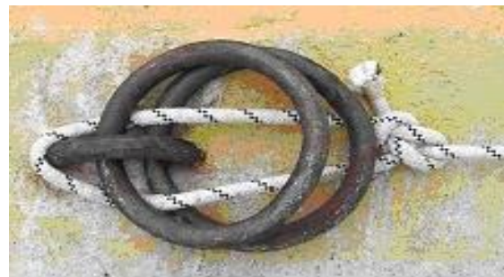
Şekil 4.24: İzborço bağı kasanın olduğu halatın çifte analeye takılması
