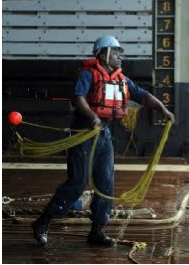
Şekil 3.5: Atılmakta olan el incesi
