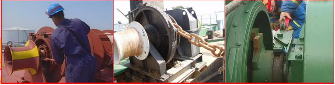
Şekil 2.27: Gomina kapanını [hareketli trnak (1)] ana dişliden [sabit trnak(2)] ayırma
