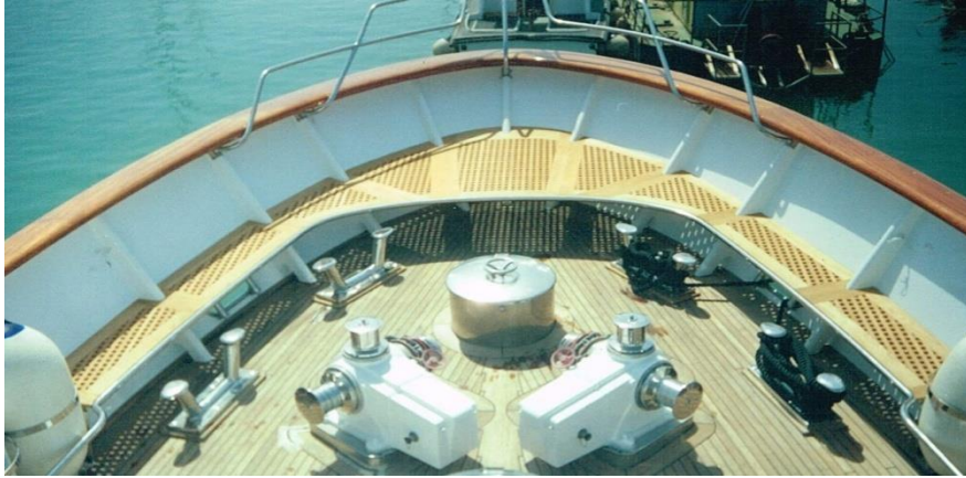
Şekil 2.20: Fenerliği yataylı ve düşeyli olan ırgatlar
