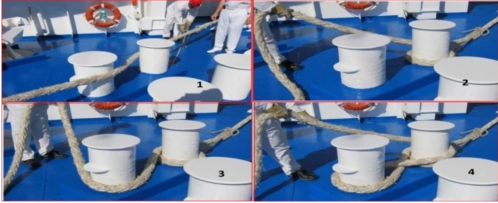
Şekil 4.15: Bosadaki halatın voltası
