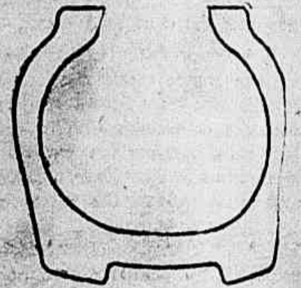
Corte transversal de um pneu com duas faixas de contato que constitui um dos recentes aperfeiçoamentos em matéria de pneus para aviões.
