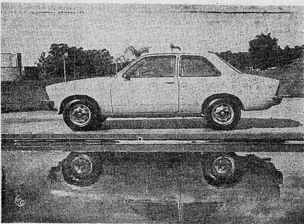
O Chevette tem perfil de linhas bastante aerodinâmicas. Nota-se que o veículo apresenta boa localização do centro de gravidade, graças à pequena altura.
