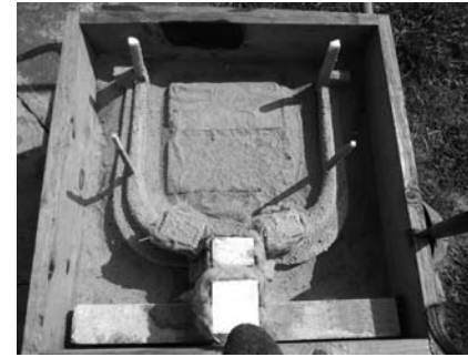
Egy távcsővilla a formázószekrényben, a homokkal való feltöltés előtt. Szépen látszanak a levegőző pálcaszerű felöntések is. A beömlő a kép alján a láda szélénél fehérlik, négyzet keresztmetszetű. Az öntvénynek itt a legnagyobb a térfogata. A beömlő mellett két zárt, és fölötte egy nyílt, kőzetgyapattal szigetelt tápféj látható is. Ekkora öntvényt már elosztócsatornákkal kellene készíteni, de megfelelő mintakészítéssel enélkül is megoldható, mivel a villán nincs nagy keresztmetszeti változás
