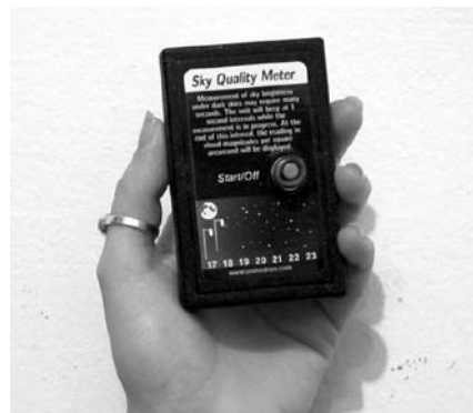
Az SQM: az égbolt fényszennyezettségének mérésére eleinte kizárólag ezt az eszközt használtuk
