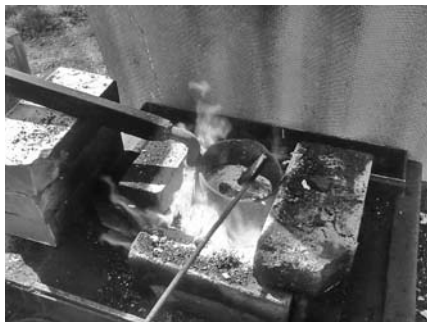
A tégely közvetlenül öntés előtt, salaklehúzás közben. A hőforrás itt egy kovácstűzhely volt, fekete szénnel megrakva. Ekkora mennyiségű (több mint 1 dm 3 ) alumínium megolvasztásához már feltétlenül szűrőlángszerű melegítés ajánlott. Figyeljük meg a a tégely felé a lehető legtöbb hőt terelő körberakott samott téglákat. A kohászati főfokon égő, levegővel erősen fűjt szénnel is mintegy 30 perc ideig tart az olvasztás!
