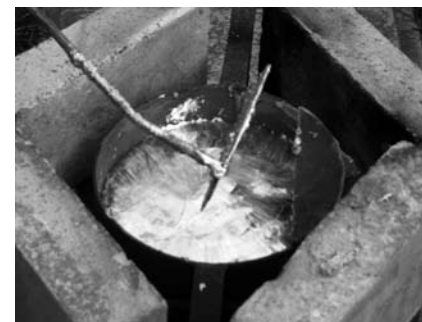
A salak lehúzása. A kapához hasonló, hosszú nyelű lehúzószerszámmal a ráncos bőrként azonnal újraképződő salakréteget egyik oldalról a másik elhúzom, majd kanalizálom mozdulattal kiemelve távolítom el. A kép formába öntés előtt 10 perccel készült
