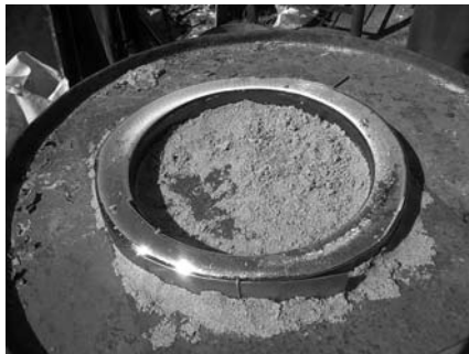
Tubusgyűrű még dermedés előtt. Figyeljük meg az itt-ott még csillogó fém felületén megjelent egyre vastagodó szürke oxidhátrát!
