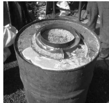
Elrepedt homoktapasz. Jó választás 200 literes acélhordót munkaasztalként használni: az elrepedt formából kifolyt anyag a hordó pereméig jutott, semmiféle veszélyt nem okozva. A szintig homokba ágyazott formánál ilyen hiba nem fordulhat elő
