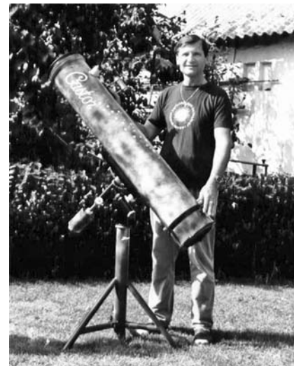
Kiss Barna Castor nevű, saját építésű 200/1200-as Newton-távcsővével
