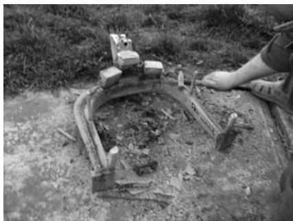
Az öntvény formából való kivételét „kírárolásnak” nevezzük. A képen a már kész öntvény látható a felöntésekkel és beömlővel, melyeket utólag kell levágni. A tisztítás kalapáccsal, finom ütésekkkel, illetve kaparással történt
