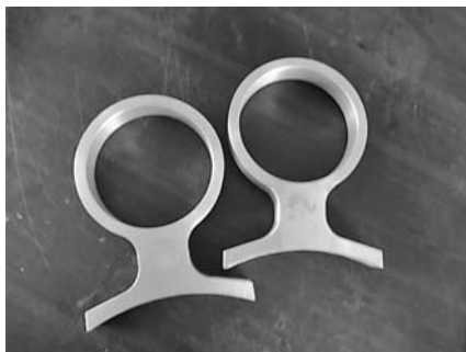
249/5000-es Cassegrain-távcsővem 100/1000-es vezetőtávcsővének öntött és már részben megforgácsolt tartói
