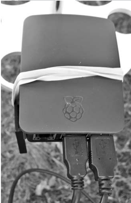
Az USB-kábelek közül az egyik az EQ3 vezérléséért felel, a másik a fényképezőgépet vezérli. A szakszerű(tlen) rögzítést postásgumival oldottam meg
