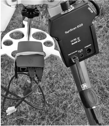
A Raspberry Pi és a goto kontrollor SynScan USB-kábellel összekötve
