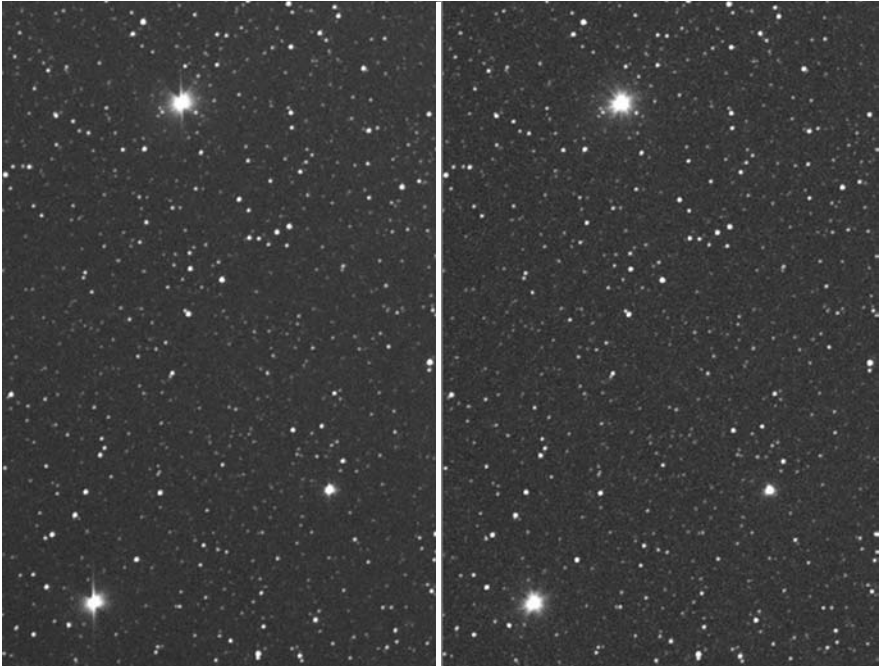
Az objektív képalkotása f/2,0 (balra) és f/2,8 (jobbra) fényerőnél. Látható, hogy nyitott rekesznél a csillagok képe villásodik
