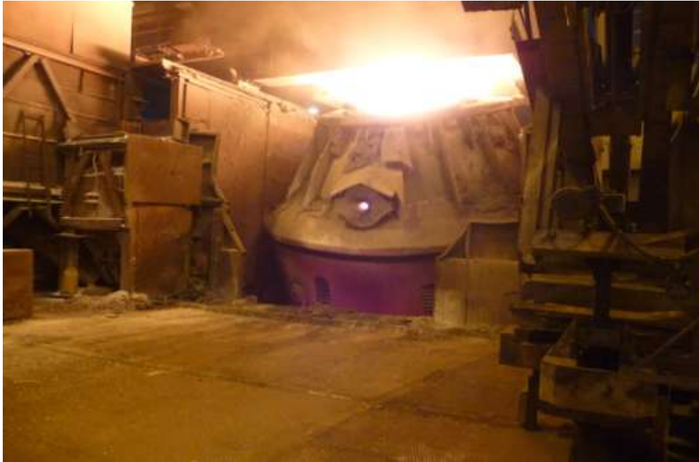
3.28. ábra A konverter buktatásának megindítása csapoláskor [2.13]
