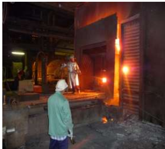
2.26. ábra Próbavétel és hőmérsékletmérés az oxigénes konvertereknél szublándzsa hiányában [2.13]
