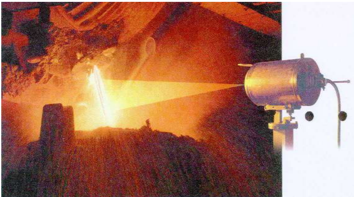
2.20. ábra Salakkifolyást dedektáló infravörös kamera [2.13]
