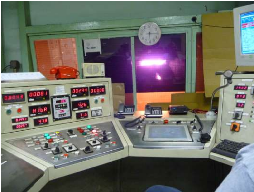
3.27. ábra A konverter fúvatásvezetői állása Dunaujvárosban [2.13]
