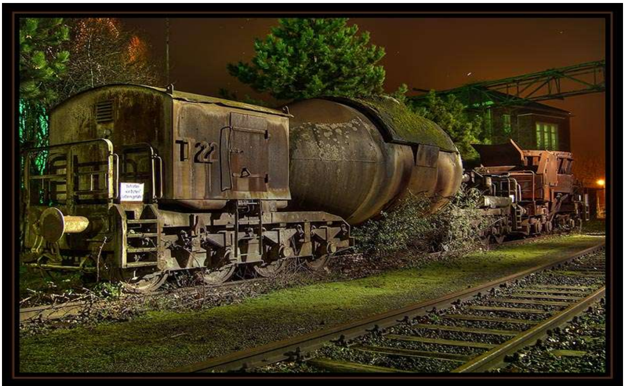
3.5. ábra Nyersvasat szállító torpedóüst [2.13]
