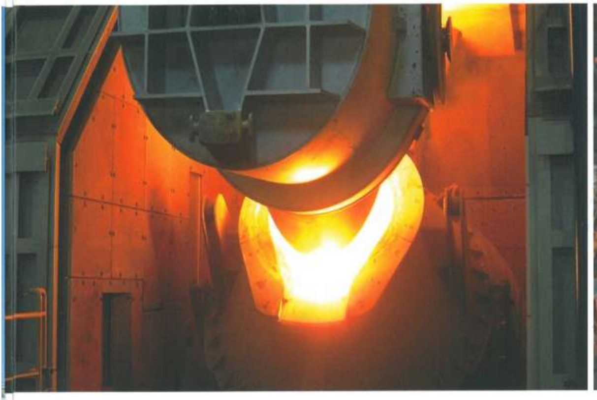
3.21. ábra A nyersvas beöntése a konverterbe
