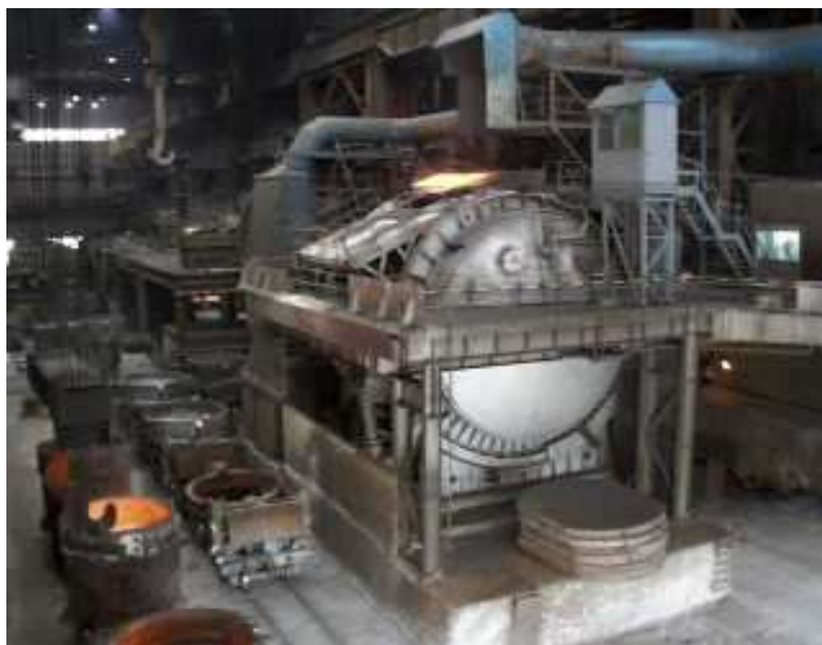
3.7. ábra Nyersvaskeverő a Dunafer Zrt-ben, előtte a beöntésre várakozó nyersvasüstök [2.13]
