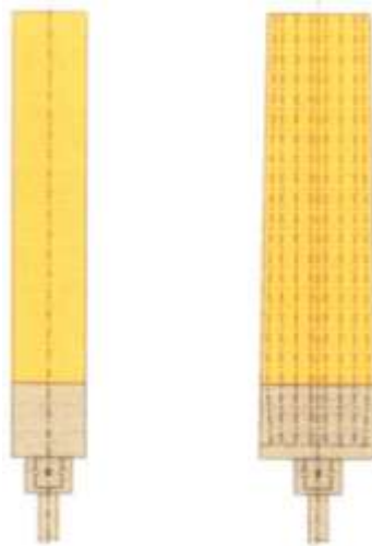
2.14. ábra A konvertertest fenékrészébe beépített öblítőkövek [2.14-2.15]
