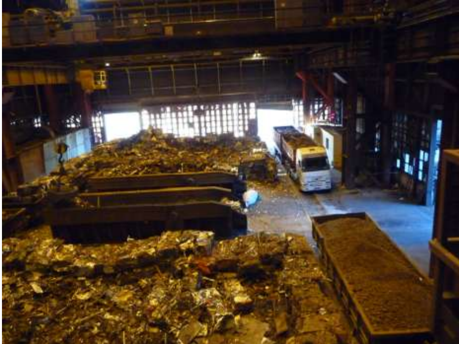
3.18. ábra Acélhulladék előkészítése a hulladékadagoló kanálba a Dunaferr Zrt Acélművében [2.13]
