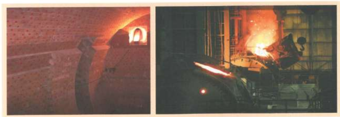
3.8. ábra A keverők falazata, ill. nyersvasbeöntés a keverőkbe
