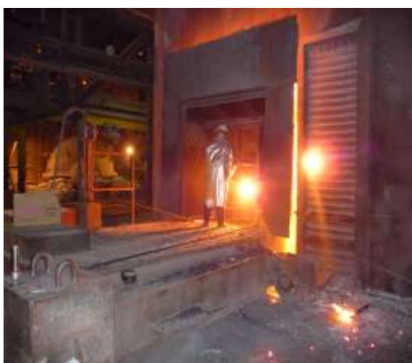
2.26. ábra Próbavétel és hőmérsékletmérés az oxigénes konvertereknél szublándzsa hiányában [2.13]
