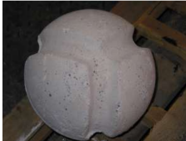
2.19. ábra Salakkifolyást gátló keramikus golyó [2.13]
