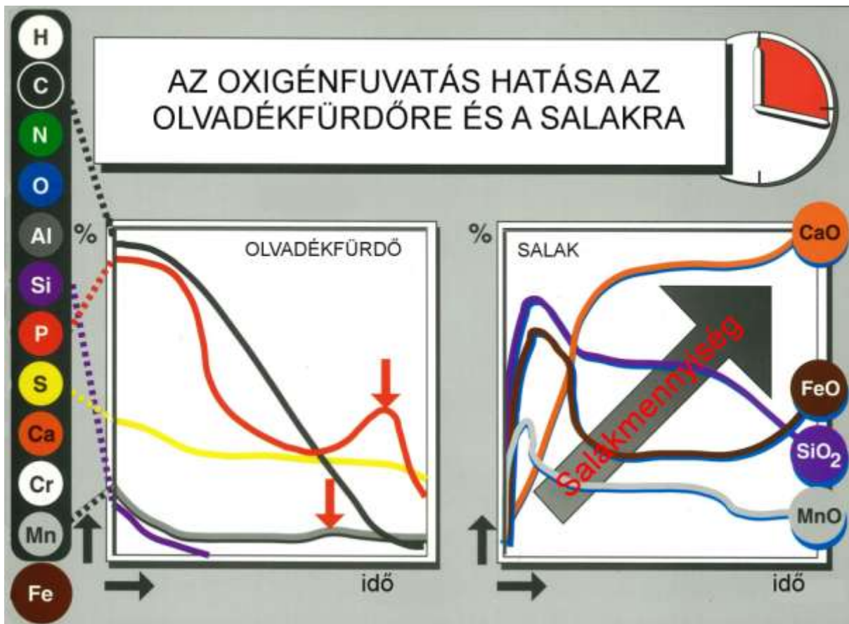
3.26. ábra A konverterekben a fúvatás időtartama alatt a folyékony betét ill. a képződött salak összetételének alakulása [3.4]
