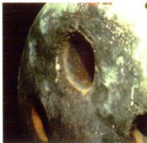
2.25. ábra A vízhűtéses rézfúvókafej használat előtti állapotban ill. használat végén [2.12]
