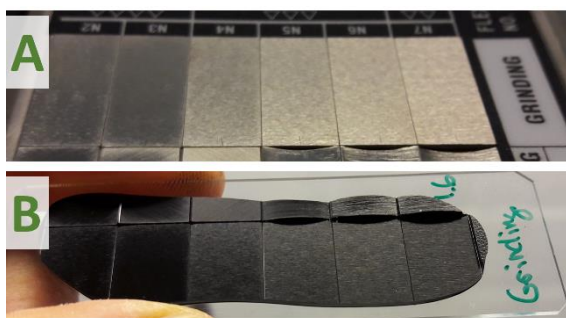
Figur 6: Visuel sanseindtryk af ruhed. Metal- (A) og polymeroverfladen (B) har begge stigende ruhed fra venstre til højre, som giver et mere mat udseende. Overfladen B er lavet som en afstøbning af A.
