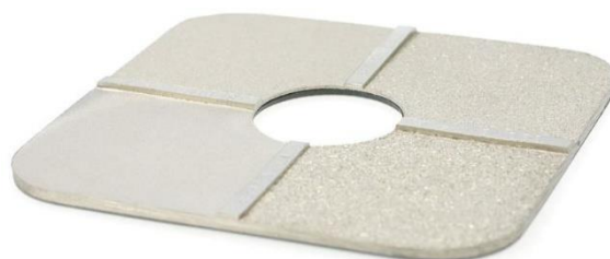
Figur 5: Ruhedskomparator til visuel og følemæssig sammenligning af sandblæste (grit blast) overflader. Ruheden på de fire felter er stigende med uret fra nederste venstre til nederste højre felt. (Billede stillet til rådighed af Clemco Danmark A/S)
