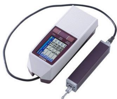
Figur 2: Eksempel på en håndholdt taktil ruhedsmåler (tastnitinstrument).
