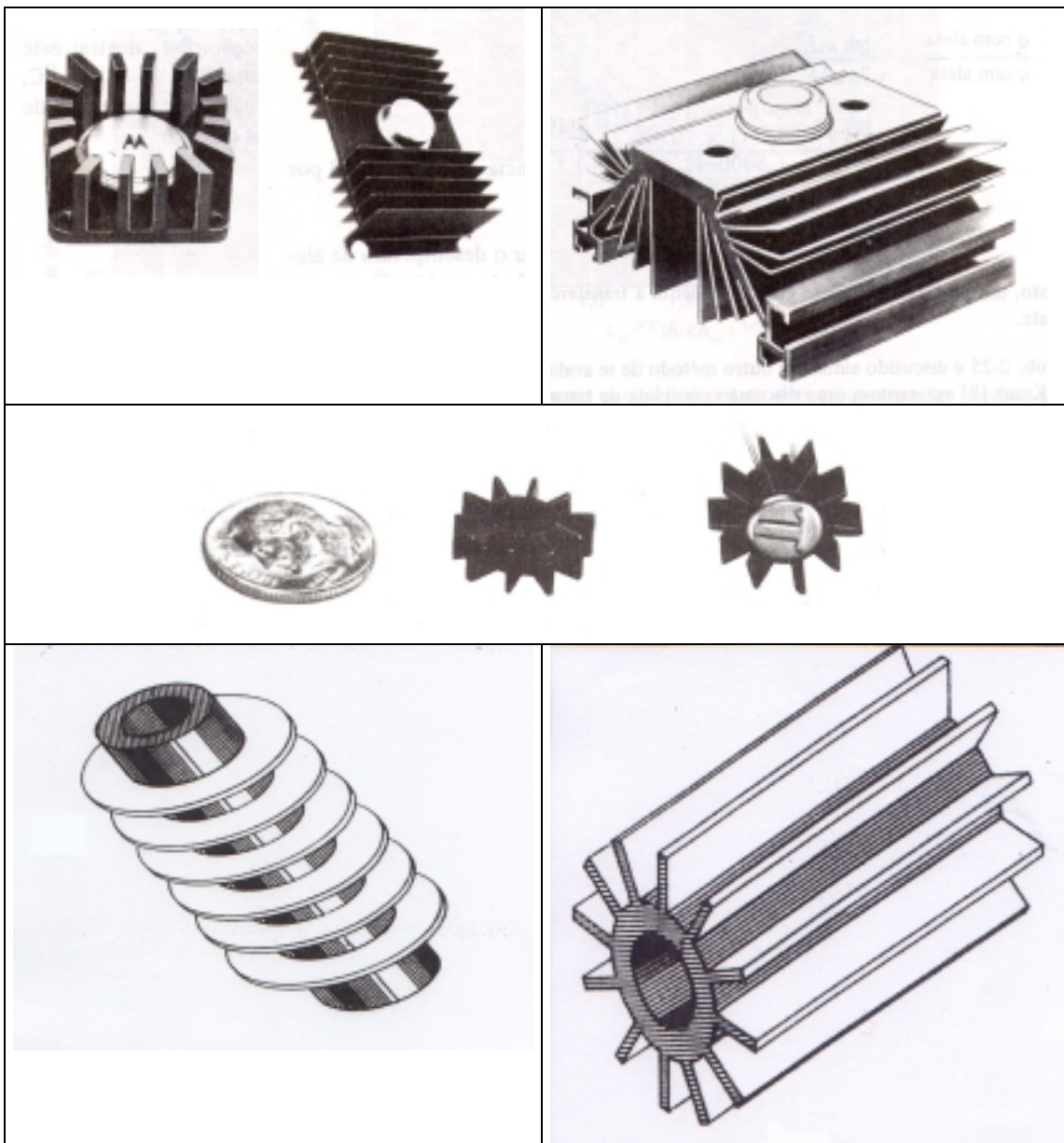
esquemas de aletas (figuras extraídas das Notas de Aula do Prof. Oliveira e de Holman, 1983)
