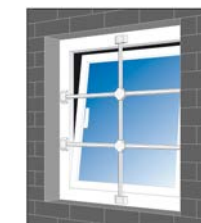
Montage auf dem Fensterrahmen
