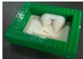
1) Préparation du moule silicone à partir du modèle imprimé en 3D
