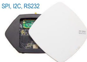
PR22 – Passerelle LoRa WAN « The Things Network »
