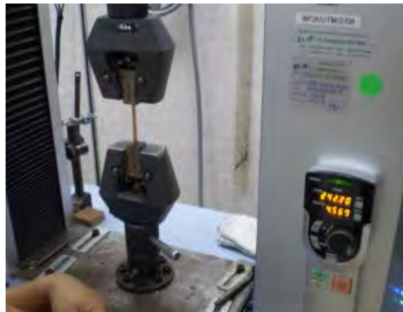
Mesin ujian universal untuk ujian kekuatan tegangan Universal testing machine for tensile strength test
