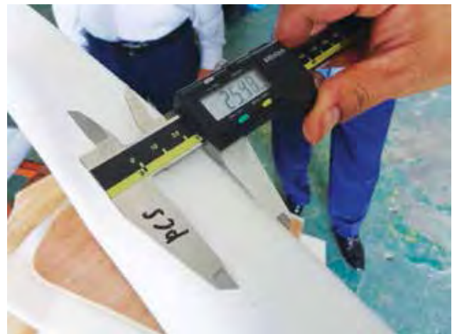
Juruaudit mengukur ketepatan ukuran produk mengikut lukisan teknikal Auditor measure the product
