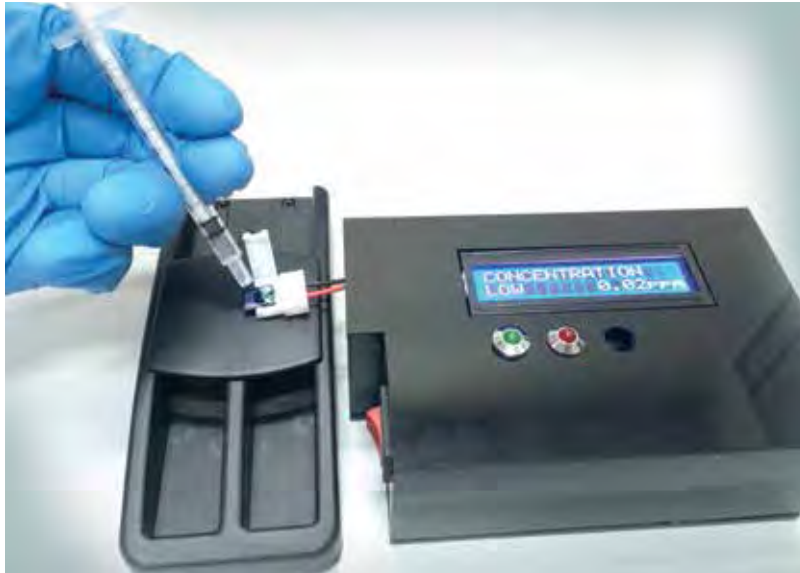
Pembinaan penderia kimia berasaskan komposit untuk pengesanan kepekaan ultra sensitif gas formaldehid yang dibebaskan daripada produk-produk komposit kayu Development of nano chemical composite sensor for ultrasensitive detection of formaldehyde gas emissions from composite wood products
