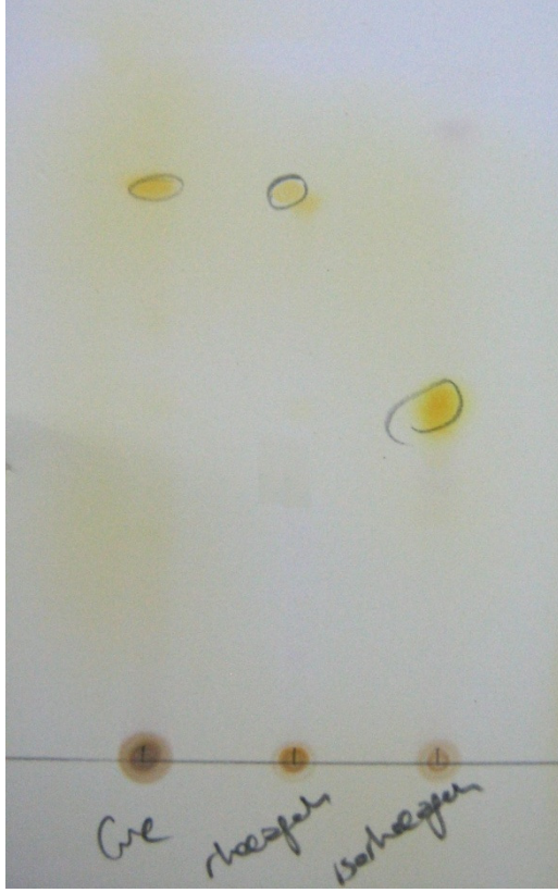
Şekil 4-8: P4 Ekstresinin Isorhoeagenine ve Rhoeagenine Alkaloitleri ile Karşılaştırılması (Sistem: II, Belirteç: Dragendorff)
