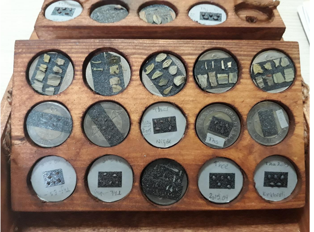
Şekil 3.1: SEM çalışması için paraların üzerine karbon bantla sabitlenerek hazırlanmış örnekler.
