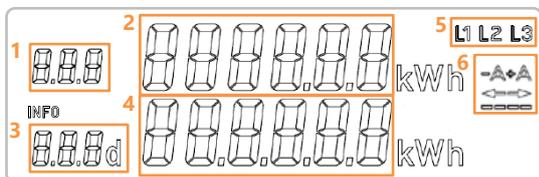
**1 Tarif-Kennziffer:** 1.8.0 kennzeichnet die Anzeige des Zählerstandes für den Gesamtenergieverbrauch, 2.8.0 kennzeichnet die Anzeige des Zählerstandes für die Gesamtenergielieferung
