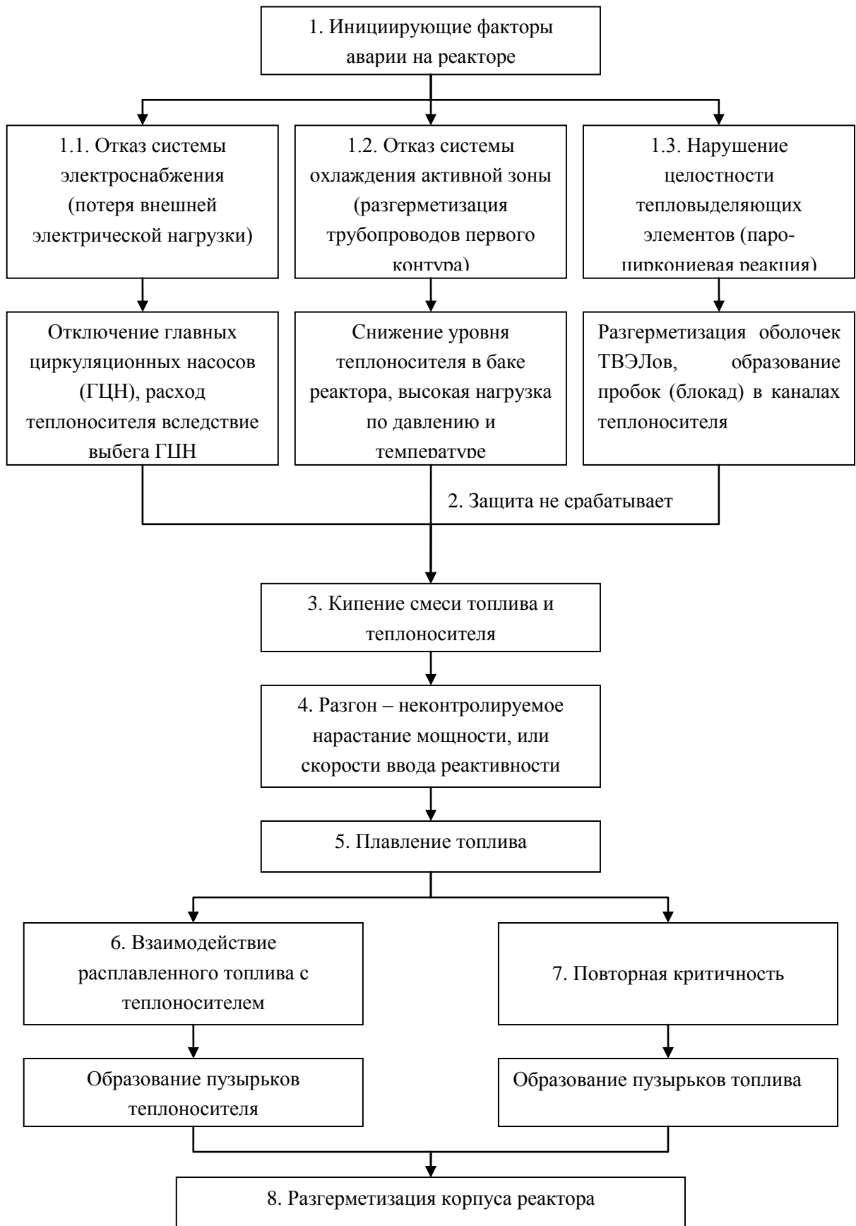
Рисунок 2 – Дерево отказов, приводящих к ядерной аварии на реакторе
