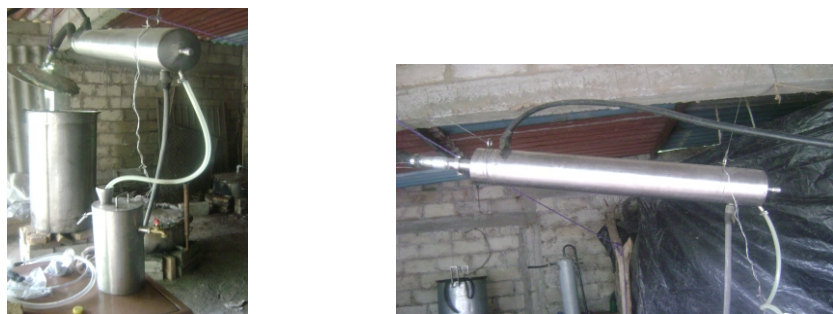
Figura 9. El serpentín en la parte derecha; la manguera de hule negro por donde llega agua fría. En la parte inferior, la manguera negra conduce la salida de agua caliente y la manguera blanca la salida de aceite mezclado con agua. En la izquierda alambique, serpentín y florentino.
