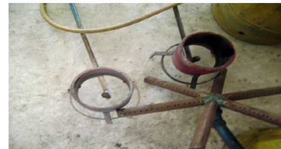
Figura 8. La caldera se calienta con una hornilla utilizando gas butano (Izquierda), se conecta con manguera de hule de pulgada y media al alambique que contiene el fruto de linaloe.
