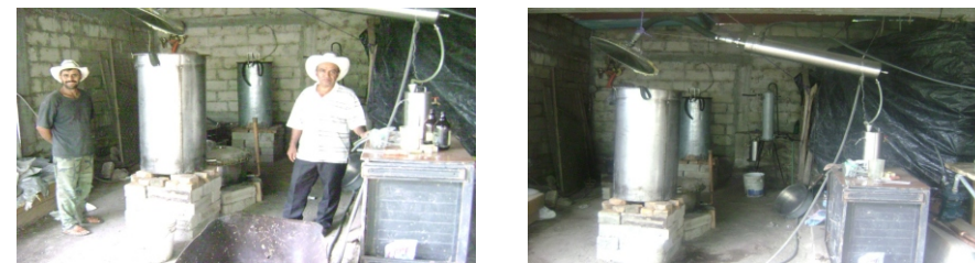
Figura 11. A la izquierda los representantes del grupo de Chimalacatlán, Mor. con el equipo completo de extracción; caldera en la parte posterior al alambique el de mayor tamaño, conectado al serpentín colocado horizontalmente en la parte superior y finalmente conectado al florentino sobre una caja improvisada.
