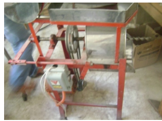
Figura 6. Molino eléctrico para triturar el fruto y así poder quitarle la semilla.
