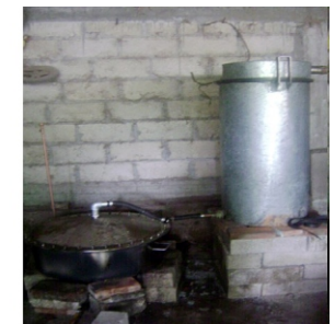
Figura 8. La caldera se calienta con una hornilla utilizando gas butano (Izquierda), se conecta con manguera de hule de pulgada y media al alambique que contiene el fruto de linaloe.
