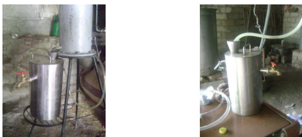
Figura 10. El florentino donde se separa el aceite del agua por diferencia de densidad. El aceite en la parte superior y el agua sale por la llave de bronce. A la izquierda una conexión y estructura más completa del florentino.
