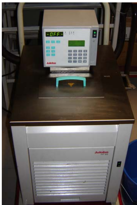
Figure 46: Cryostat Junbo II (précis à \pm 0,1^{\circ}\text{C} ) utilisé pour le calibrage du pyromètre
