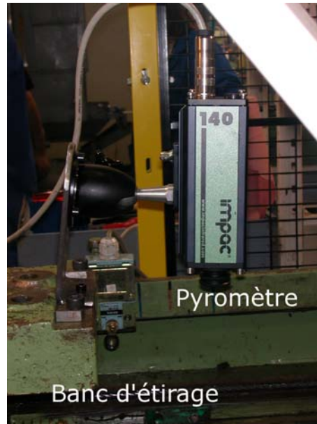
Figure 50: Placement du pyromètre sur le banc d'étirage
