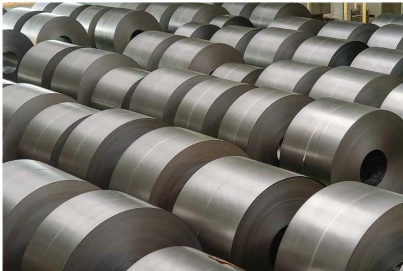
*Figura 2.5. El acero laminado en frío se almacena y vende en forma de rollo después del laminado.*
