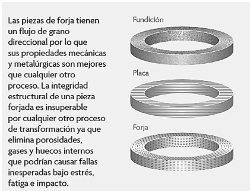
*Figura 3.8. Orientación de las fibras obtenido mediante forja.*
