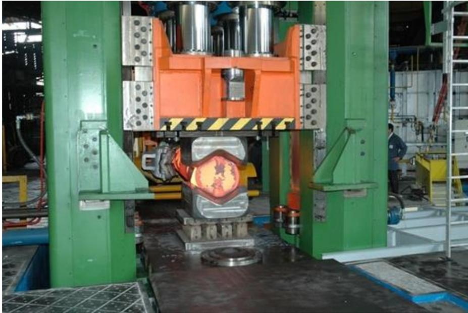
*Figura 3.4. Prensa hidráulica*
