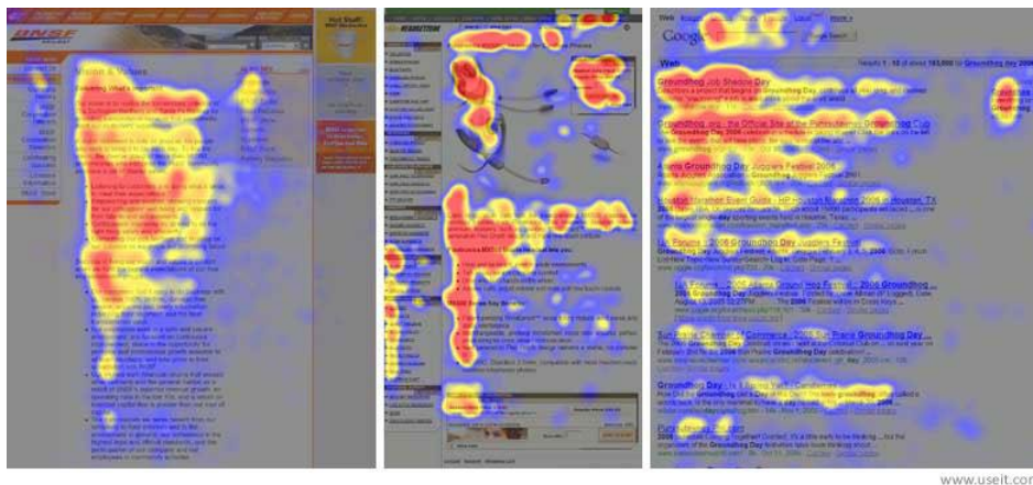
10. ábra: F és E alak-ban olvasás a képernyőről – Jakob Nielsen híres szemmozgáskövető vizsgálatának eredménye 27
