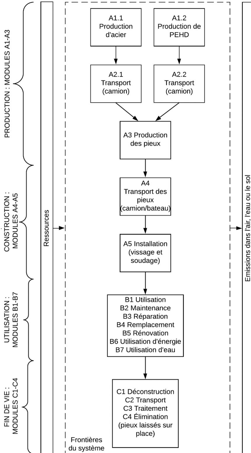
Figure 1 – cycle de vie du Techno Pieux P3-10 (pieu et rallonge) non galvanisé
