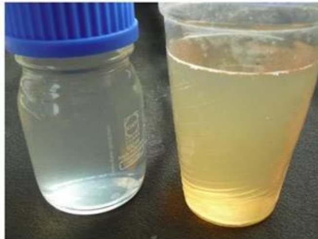
Gambar 5. Limbah hidrokarbon yang telah diproses dengan biosurfaktan dan bioflokulan.
