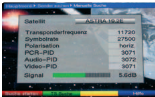
Installation: Per Signalpegelanzeige des Receivers lässt sich eine Satellitenantenne eher ungenau ausrichten
