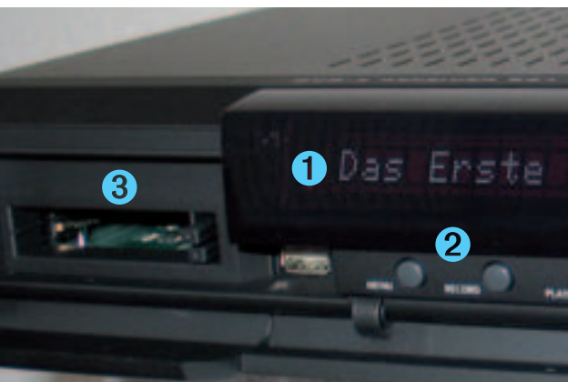
Das Display des Kathrein UFS 821 zeigt Sendernamen 1 an, MenütaSten 2 erlauben die Bedienung, links zwei CI-Slots 3
