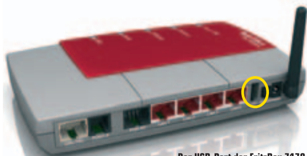
Der USB-Port der FritzBox 7170 ist Netzwerk-tauglich – so lassen sich Videos über externe Festplatte drahtlos verteilen (Trick 42)
