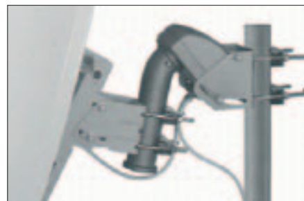
Ein montierter USALS-Drehmotor – die Weiterleitung der Steuerungssignale für die Positionierung erfolgt über konventionelles Koaxialkabel
