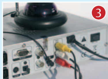
TV-Gerät 2 wird mittels Cinch-AV an den Receiver angedockt, über diese Verbindung gibt es ein ausreichendes Bild und Stereo-Sound.
