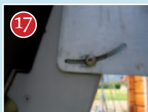
Einstellung der Deklination. Als Ausgangspunkt wird laut Bedienungsanleitung ein Winkel von 40° angenommen. So erklären sich die am Testort eingestellten 33°, die einer Deklination von 7° entsprechen.
