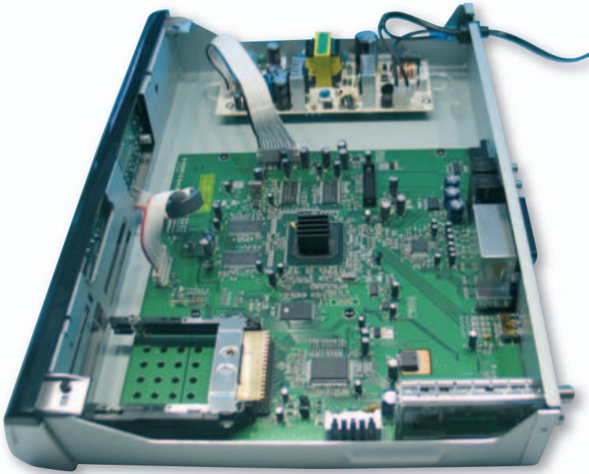
Platz im Gehäuse dank Multifunktions-Chips: Für eine Festplatte würde es reichen
