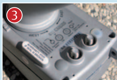
3 DiSEqC-Motore sind einfach anzuschließen. Die Buchsen sind mit Text und kleinen Bildern beschriftet.
