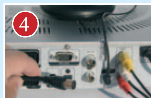
Über den UHF-Ausgang können zusätzliche Fernseher angeschlossen werden, das lässt etwa die abwechselnde Nutzung des zweiten Tuners in mehreren Räumen zu.
