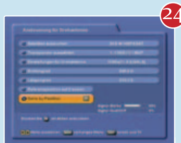
24 ... ist nur noch die Satellitensuche zu starten. Der Receiver errechnet die genaue Position aus und dreht die Schüssel. Ein aktiver Transponder muss nicht eingestellt werden.
