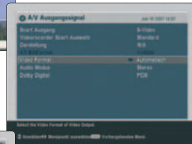
Die Videoausgabe erfolgt in 576i/p, 720p oder 1.080i – bei der Option „automatisch“ bleibt bei vielen HDMI-Displays der Schirm schwarz
