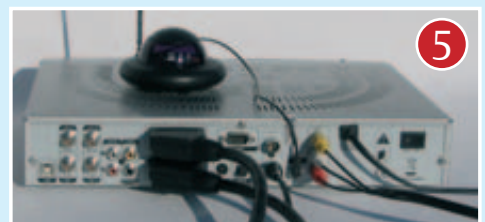
Vollständig angeschlossener Receiver: An den beiden SCART-Buchsen sind der Hauptfernseher und ein DVD-Rekorder angeschlossen.
