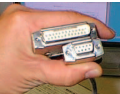
Verbinden Sie den Receiver rechnerseitig über ein Nullmodem-Kabel mit 9-Pol- oder 25-Pol-Buchse
