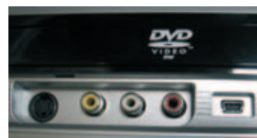
Hinter der Frontblende warten USB-Anschluss und externe Eingänge zur Archivierung auf HDD oder DVD
