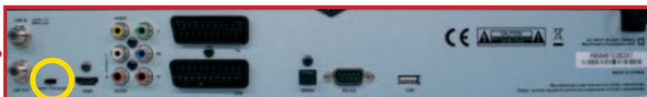
Der TF-7700 HSCI kann nicht gleichzeitig Bilder über YPbPr-Cinch und SCART ausgeben – per Schiebeshalter (Bild rechts) wird gewechselt; die USB-Buchse dient nur Servicezwecken, eine Festplatte ist nicht eingebaut
