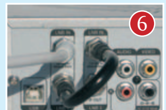
Bei Festplatten-Receivern durchaus üblich, für Multiroom-Geräte nicht empfehlenswert: Das Durchschleifen der Sat-Anschlussleitung zu Tuner 2.
