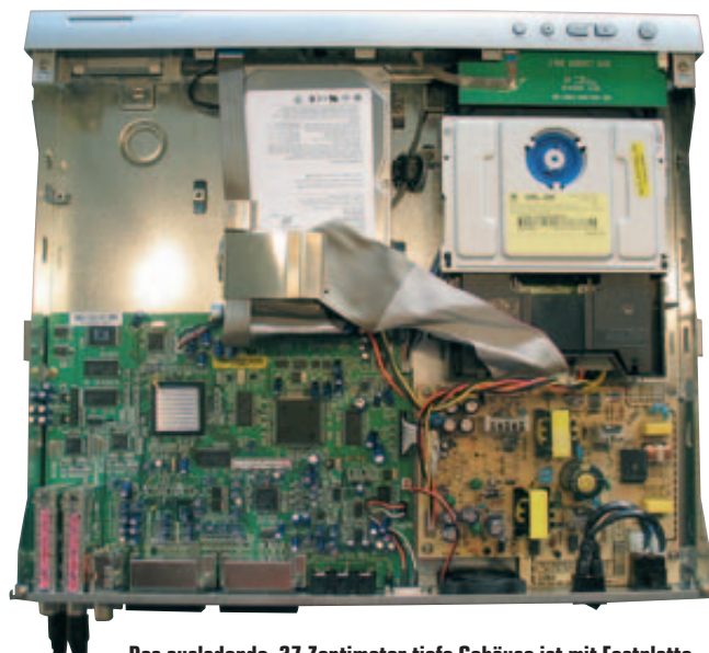
Das ausladende, 37 Zentimeter tiefe Gehäuse ist mit Festplatte, DVD-Rekorder, Hauptplatine und Netzteil nahezu vollständig ausgefüllt
