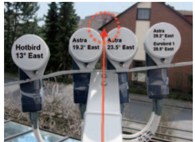
↑ Tatsächliche Ausrichtung des Spiegels: Gut zu erkennen: gelber und roter Pfeil streifen jeweils die Hausecke, was die Qualität des Verfahrens verdeutlicht
