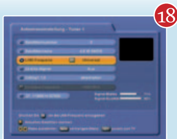
18 Für jede Satellitenposition ist zu überprüfen, ob der eingestellte LNB-Typ mit der Empfangseinheit in der Antenne übereinstimmt.
