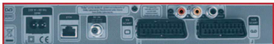
Abgesehen vom Netzwerk-Anschluss müssen die „Premiere Interaktiv“-Receiver mit einem stark abgespeckten Anschlusspanel auskommen – an der Vorderseite fällt selbst das LC-Display dem Sparkurs zum Opfer
