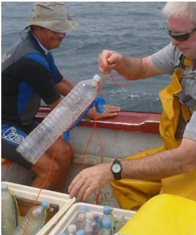
Fig. 16 — Micro-casiers constitués de bouteilles plastique modifiées, contenant un appât, avec un fond constitué d'une entrée en entonnoir. Utilisés pour l'échantillonnage des crustacés et mollusques autour de la Guadeloupe (adapté de Poupin 2018, fig. 17). Ces structures légères et peu coûteuses pourraient être déposées entre les coraux lors des futures plongées mésophotiques à Mayotte (projet CRUMMA).
