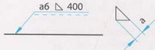
Figura 11 Quotatura delle saldature d'angolo.
