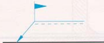
Figura 13 Indicazione di saldatura da eseguire in cantiere.
