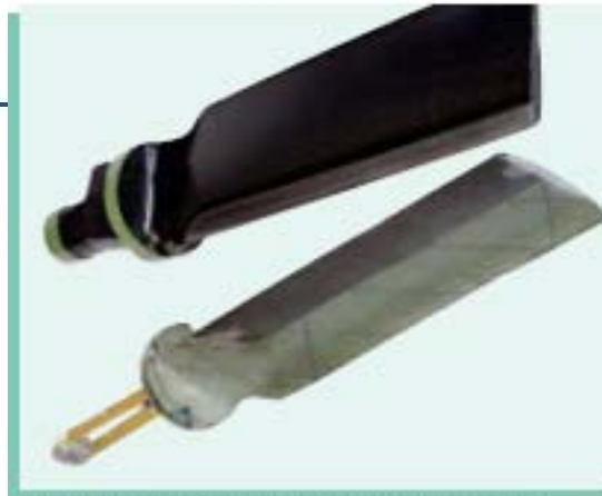
Aerospaziale: Incollaggio bordo d'attacco delle pale dell'elicottero
