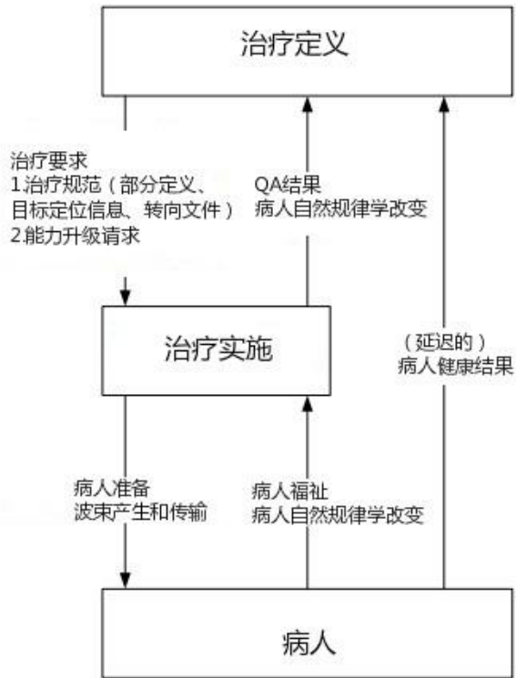
图 B.3: 质子治疗机的高级 (抽象) 控制结构
