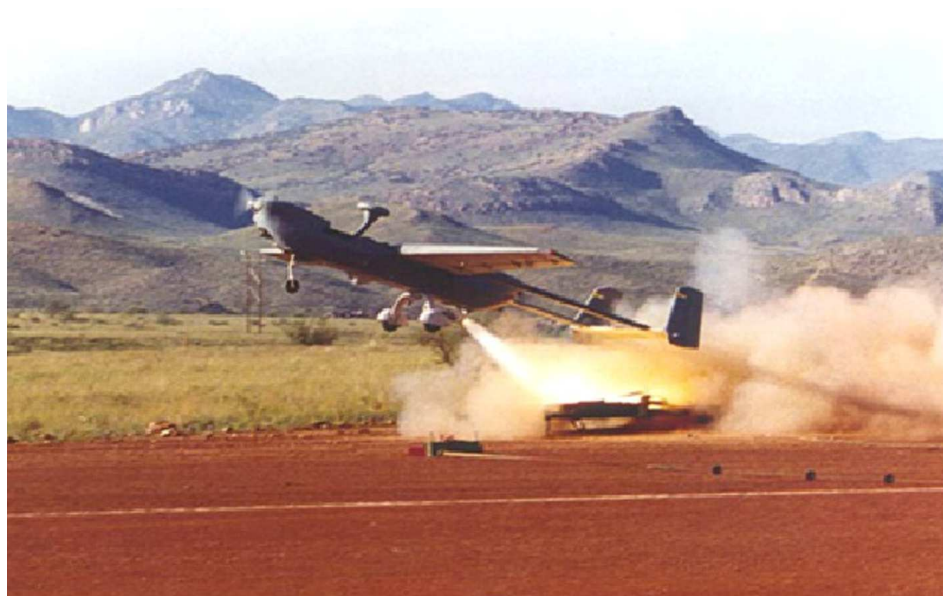
Rys. 2. Start BSL z wykorzystaniem rakiety wspomagającej [3]
