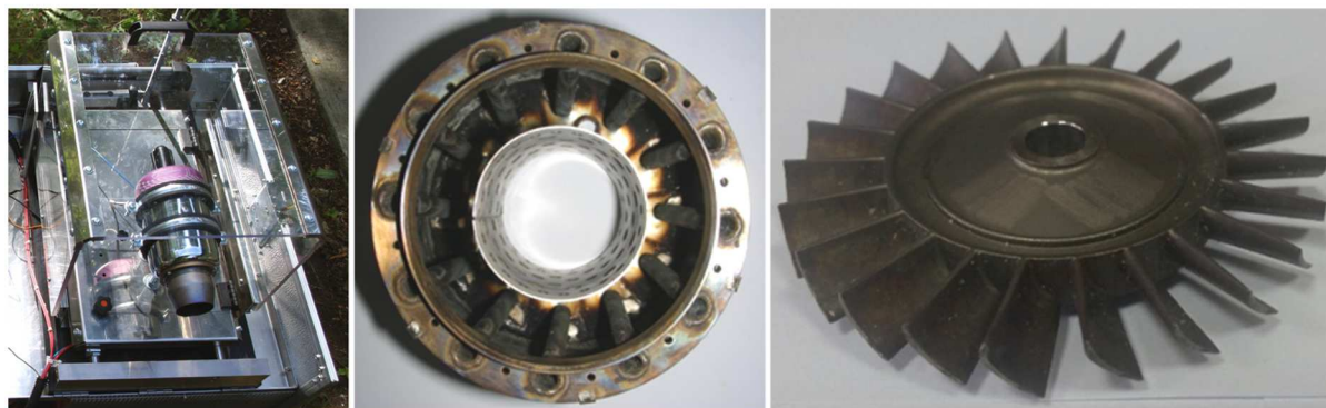
Rys. 1. Silnik JetCat P140 RX zamontowany na stanowisku badawczym oraz jego komora spalania i monolityczny wirnik turbiny
