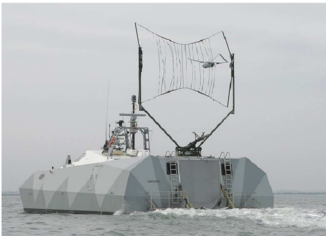
Rys. 3. Wychwytywanie BSL za pomocą siatki [4]
