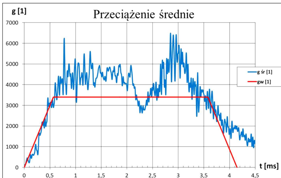
Rys. 19. Uśredniony zapis przeciążeń z trzech czujników 7270A-20k
