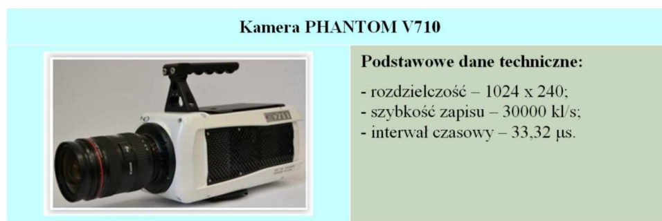
Rys. 8. Widok kamery PHANTOM V710 oraz jej podstawowe parametry techniczne
