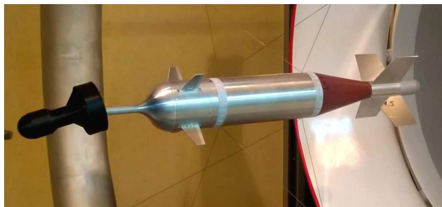
Rys. 1. Model badanej bomby w tunelu aerodynamicznym
