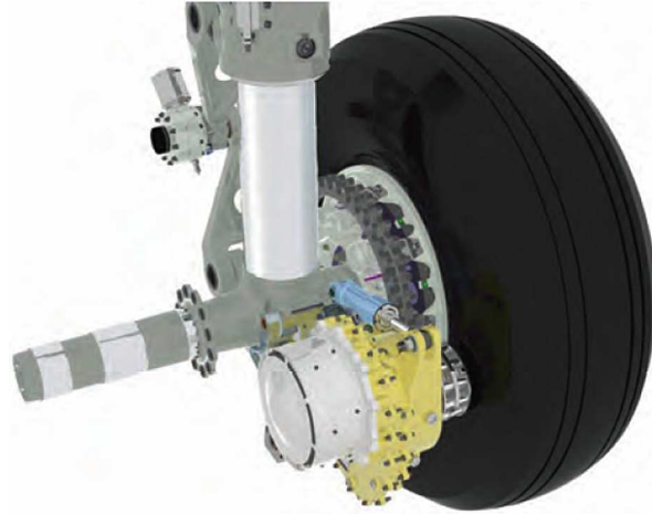
Rys. 14. Jeden z projektów EGTS z pojedynczym silnikiem elektrycznym i przekładnią planetarną [4]
