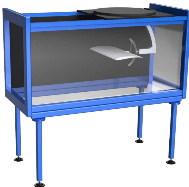
Rys. 1. Model kanału stworzony do symulacji dynamicznej ruchu skrzydła [1]
