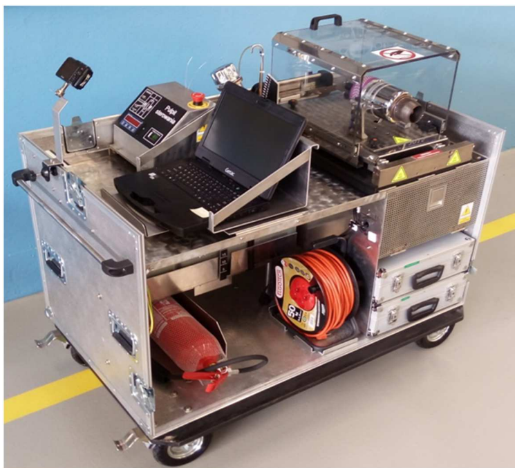
Rys. 2. Stanowisko przygotowania i obsługi silników wykorzystane w badaniach
