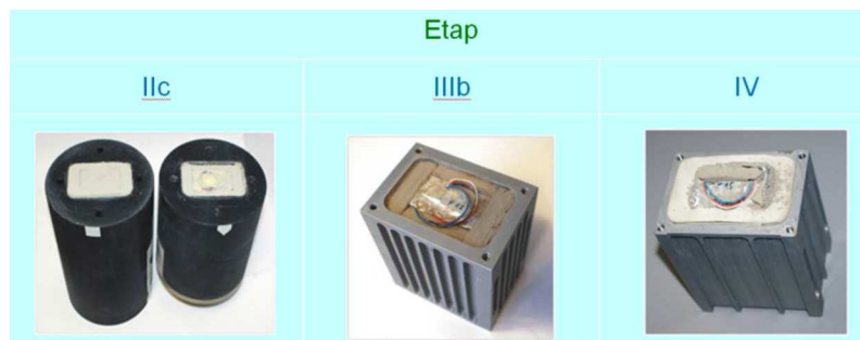
Rys. 12. Widok pakietu elektroniki po wykonaniu testów
