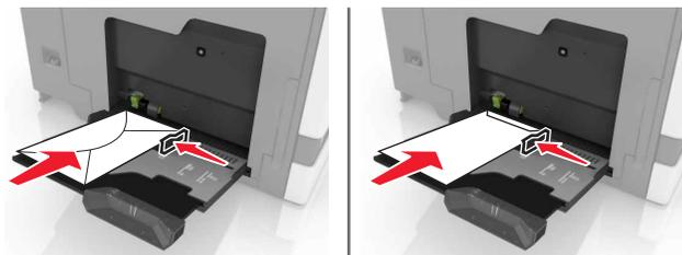
**Warnung—Mögliche Schäden:** Es dürfen keine Umschläge mit Briefmarken, Metallklammern, Haken, Fenstern, Fütterung oder selbstklebenden Klebeflächen verwendet werden.
