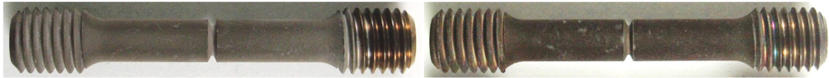
Abb. 4.15: Exemplarische gestrahlte Kerbzugproben, die bei 2 \text{ A/dm}^2 im glanzbildnerfreien Membrantechnik-Bad mit 212 \text{ Ah/l} ZnNi-beschichtet wurden links: Transparentpassivierung; rechts: Gelbchromatierung
