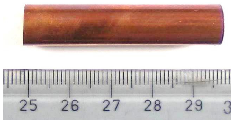
Abb. 4.43: Kupferstab als Substrat für Metallüberzüge
