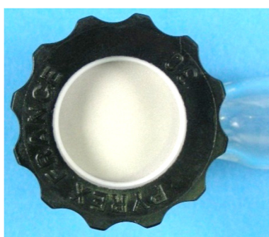
Abb. 3.12: In Tauchzelle eingespannte Stahlmembran
