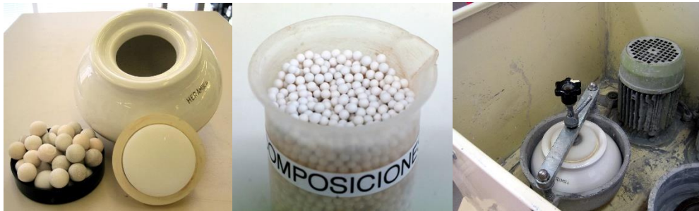
Figura 6. a) Molino de laboratorio de 400 g de sólido junto a bolas de molturación medianas; b) Bolas pequeñas de molturación; c) Molino de laboratorio instalado en bastidor planetario (Fuente: ITC)
