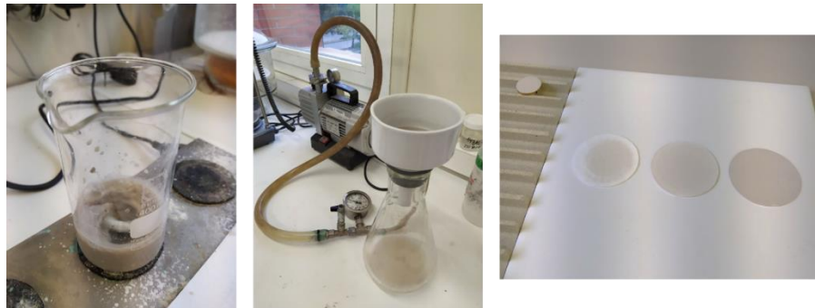
Figura 31. Preparación de barbotinas para análisis mediante MEB: a) Desleído de la barbotina; b) Filtrado a vacío; c) Portaobjetos con gota de barbotina y filtros a varias concentraciones.
