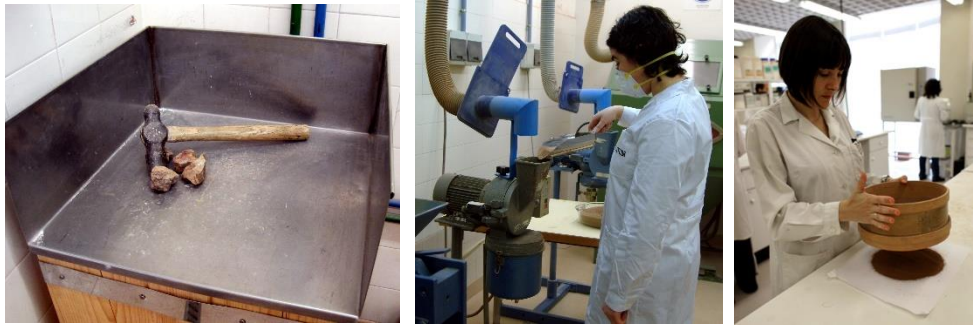
Figura 3. Acondicionado de las materias primas a granel: a) Trituración manual a martillo; b) Trituración en molino de martillos; c) Tamizado vía seca manual. (Fuente: ITC)
