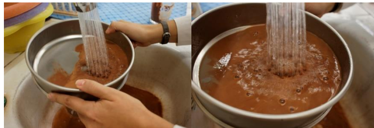
Figura 7. Medida de rechazo en tamiz vía húmeda. (Fuente: ITC)
