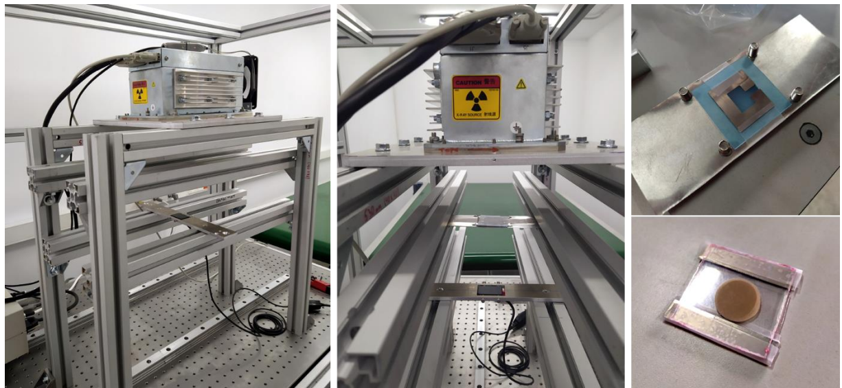
Figura 60. Montaje preliminar del sistema de adquisición de imágenes por transmisión de rayos X con perfilería de aluminio dentro del bunker radiológico. En la esquina inferior derecha se puede observar la fina capa de muestra a analizar.
