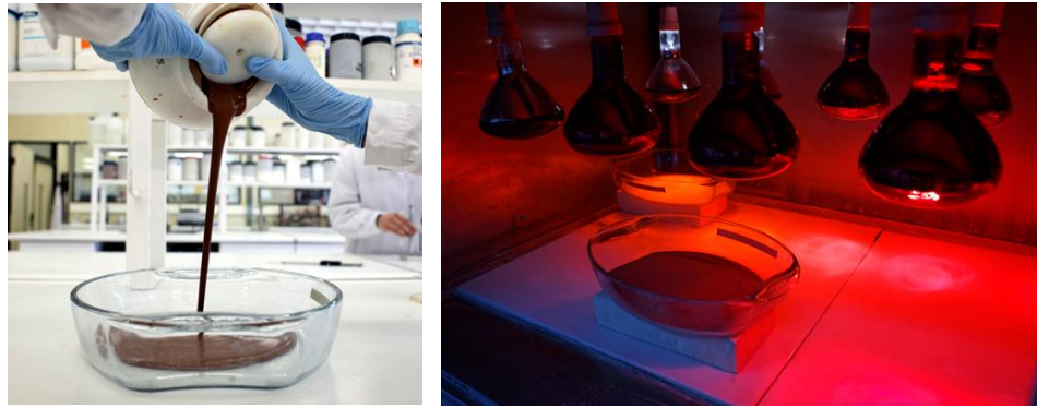
Figura 8. a) Descarga de molino de laboratorio sobre bandeja de vidrio; b) Secado de una bandeja de vidrio en lámparas de infrarrojos (Fuente: ITC).
