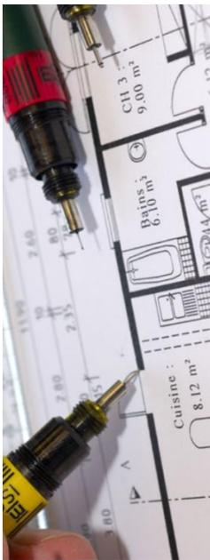
**Planos de Obra:** Ejecutados generalmente en Escala 1:50, muestran el desarrollo de las plantas, cortes y fachadas con detalle de los materiales de terminación, carpinterías, cotas, medidas, designación de locales, etc. Todo lo necesario para ejecutar correctamente la obra.
