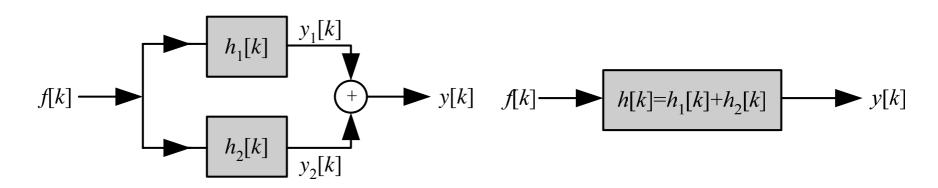
例1 求图示系统的冲激响应。其中 $h_1(t)=e^{-3t}u(t)$ ,
