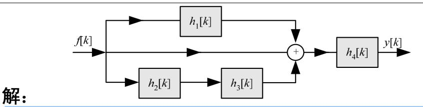
子系统 $h_2[k]$ 与 $h_3[k]$ 级联, $h_1[k]$ 支路、全通支路与 $h_2[k]$   $h_3[k]$  级联支路并联,再与 $h_4[k]$ 级联。
