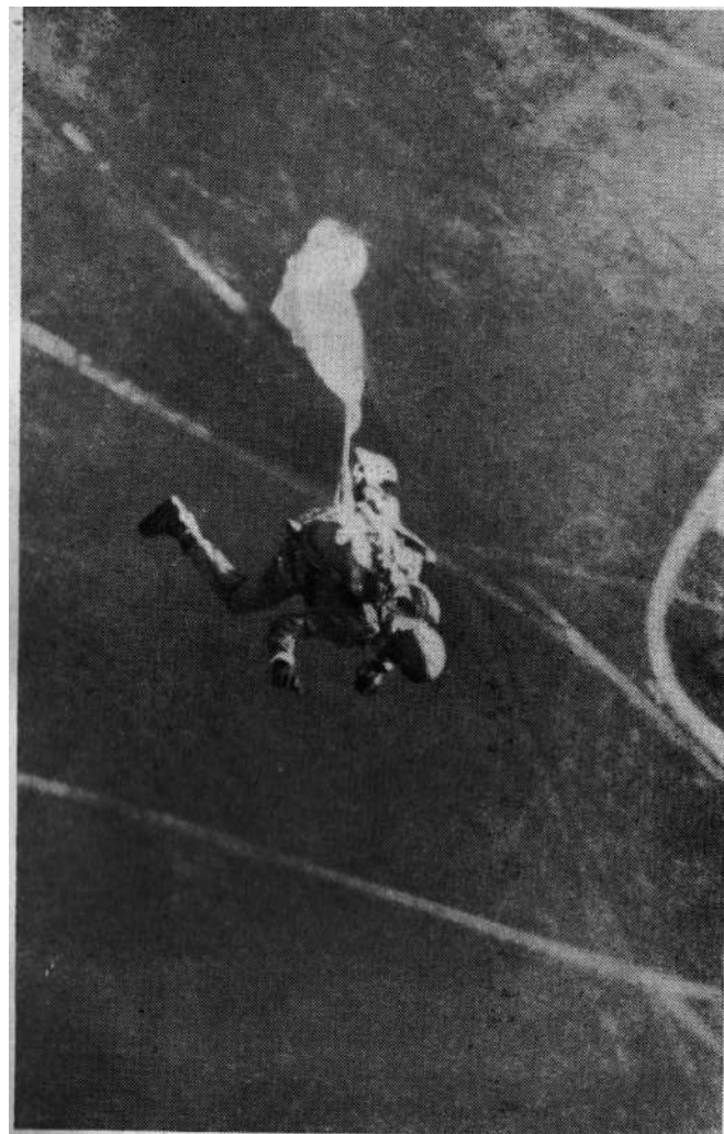
04. Käsiavamisega hüpe. Avamiserõngas on välja tõmmatud, ranitsahõlmad avari. Õhuga täituv ekstraktor alustab tööd.
