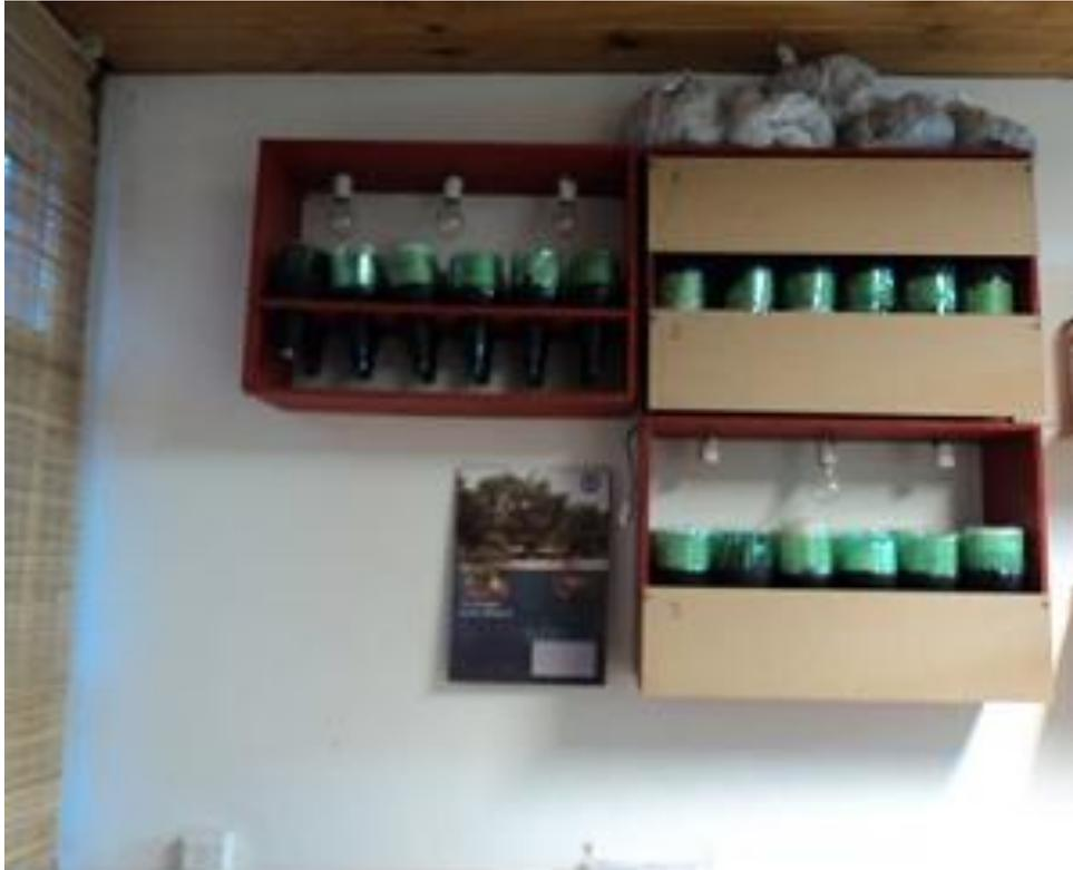
**Figura 2.4b. Extractores libres y tapados con paredes de cartón prensado**
