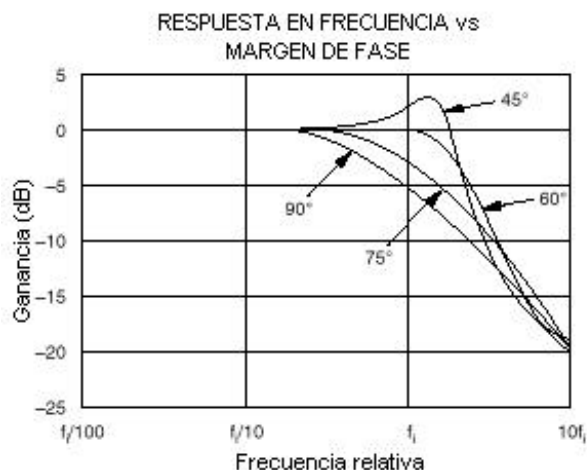
Figura 24. Efectos del margen de fase en la respuesta en frecuencia.
