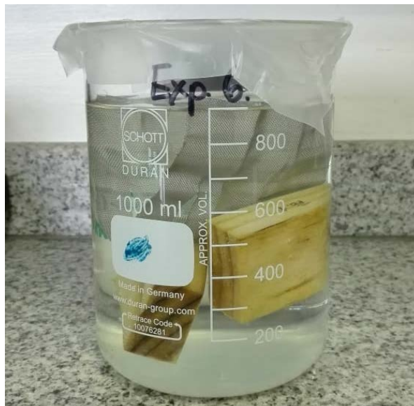
Figura 9: Probetas en Vaso precipitado, Posterior al Ingreso del Silicato.
