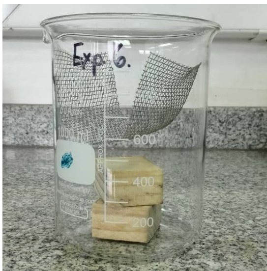
Figura 8: Probeta en Vaso Precipitado, Previo al Ingreso del Silicato.
