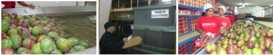
Figura 75. Tratamiento Hidrotérmico de mango (Fotos: Lab. Entomología de Guayaquil)
