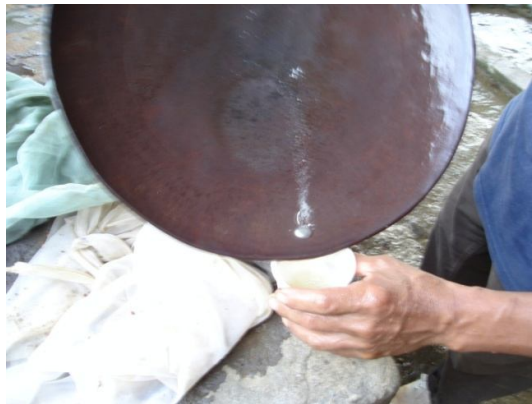
Foto 2.19: Recuperación de mercurio
