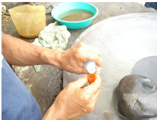
Foto 2.15: Adición de mercurio.
