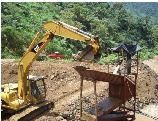
Foto 2.1: Extracción en yacimiento aluvial con maquinaria pesada
