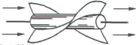
Figura 5.2 Funcionamiento del dispositivo de turbina tipo Woltman.
