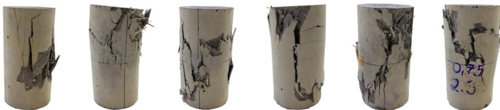
Figura 51: modos de fratura, mistura PE-W5F75. Corpos de prova, da esquerda para a direita, 1.1, 1.2, 1.3, 2.1, 2.2 e 2.3.
