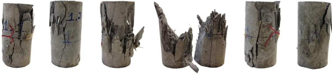
Figura 49: modos de fratura, mistura PE-W5F25. Corpos de prova, da esquerda para a direita, 1.1, 1.2, 2.1, 2.2, 3.1 e 3.2.
