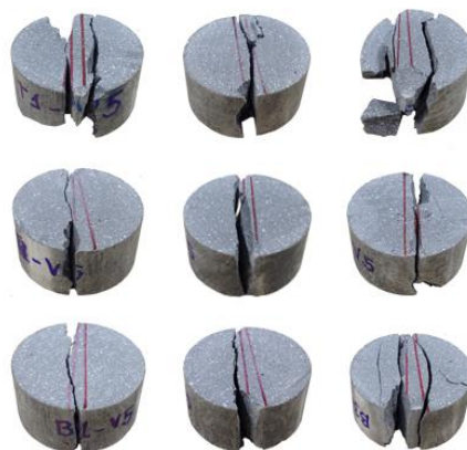
Figura 58: modo de fratura, mistura PE-W5. Colunas da esquerda para a direita: corpos de prova 1, 2 e 3; linhas de cima para baixo: topo, meio e base de cada corpo de prova.
