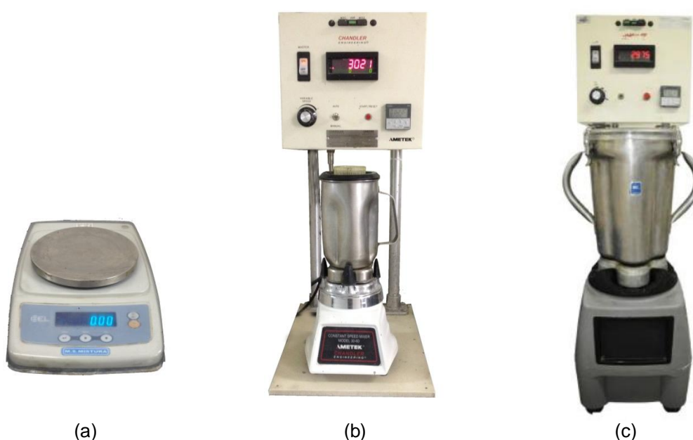
Figura 14: balança de precisão com incerteza de 0,01g (a); misturador Waring Blendor da Chandler Engineering, modelo 30-60, capacidade de 1 L (b); e misturador Waring Blendor da Chandler Engineering, modelo 30-70, capacidade de 4 L (c).
