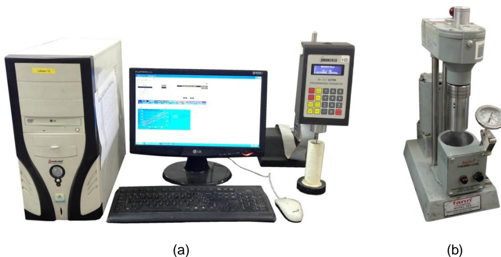
Figura 18: reômetro Brookfield Engineering modelo DV-III ULTRA (HB) ligado à um computador com software Rheocalc (a) e viscosímetro da FANN, modelo 35A (b).
