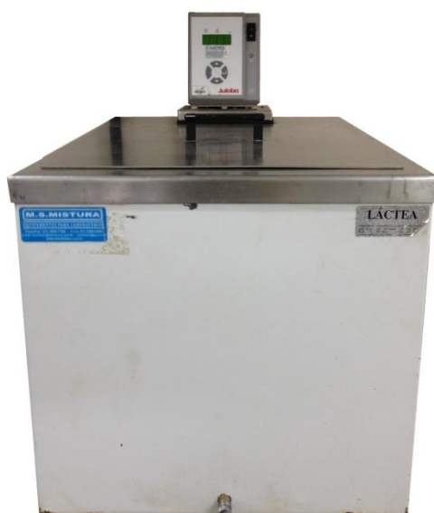
Figura 16: banho térmico para rampa de aquecimento de 23°C a 74°C.
