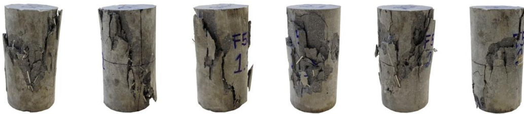
Figura 50: modos de fratura, mistura PE-W5F50. Corpos de prova, da esquerda para a direita, 1.1, 1.2, 1.3, 2.1, 2.2 e 2.3.
