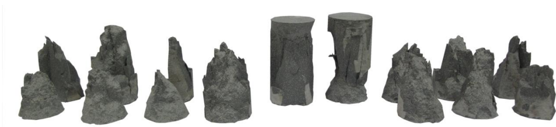
Figura 47: modos de fratura, mistura PRSA. Corpos de prova, da esquerda para a direita, 8, 9, 10, 11, 12, 13, 14, 15 e 16.
