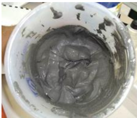
Figura 12: aspecto da pasta de referência confeccionada com relação a/mc de 0,50. Retirado de BARGHIGIANI (2013).
