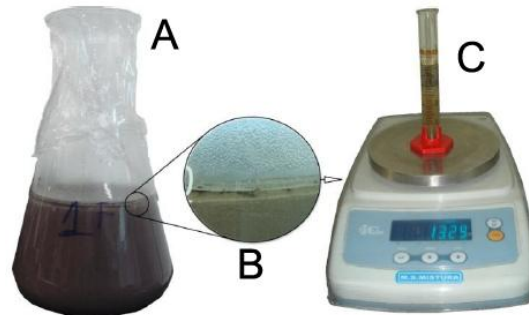
Figura 8: ensaio de fluido livre ambiente. A- pasta em repouso; B- água sobrenadante; e C- obtenção de massa e volume de água sobrenadante. Retirado de VITORINO (2012).
