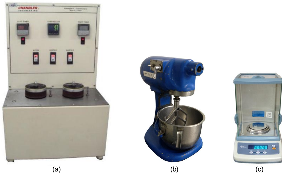
Figura 15: consistômetro atmosférico modelo 1200 da Chandler Engineering (a); misturador planetário (b); e balança de altíssima precisão, com incerteza de 0,0001g (c).
