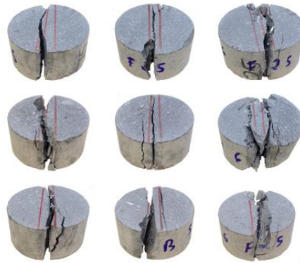
Figura 59: modo de fratura, mistura PE-W5F25. Colunas da esquerda para a direita: corpos de prova 1, 2 e 3; linhas de cima para baixo: topo, meio e base de cada corpo de prova.
