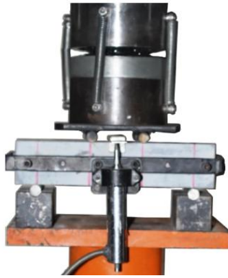
Figura 23: setup do ensaio de resistência à tração na flexão. Retirado de VITORINO (2012).
