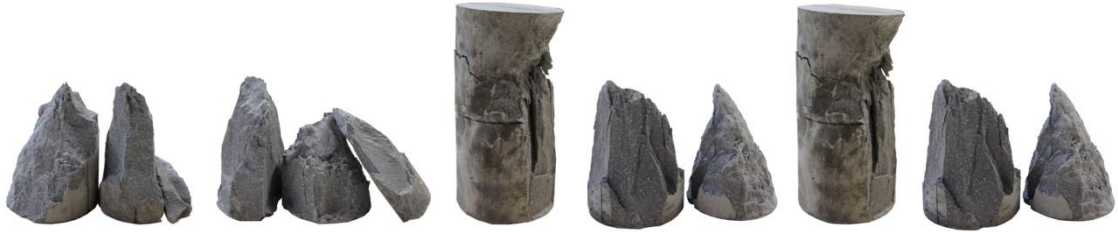
Figura 48: modos de fratura, mistura PE-W5. Corpos de prova, da esquerda para a direita, 1.1, 1.2, 1.3, 2.1, 2.2 e 2.3.
