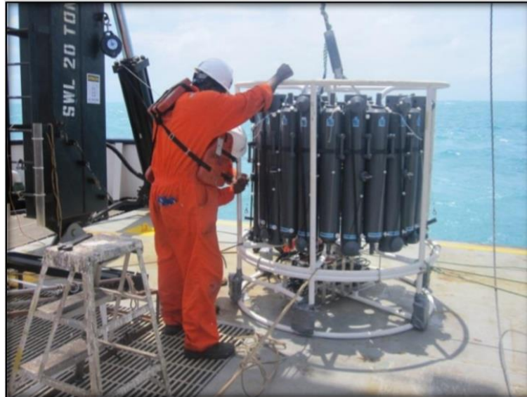
Figura 7- CTD/Rosette com capacidade para 24 garrafas
