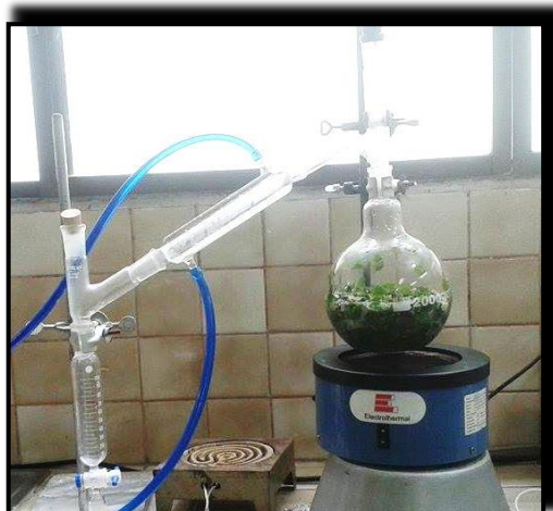
Figura 5: Equipo de hidroddestilación empleado para la extracción del aceite esencial de Minthostachys mollis .
