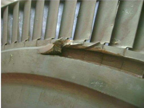
Figura 42 Detalle de la fractura en el disco
