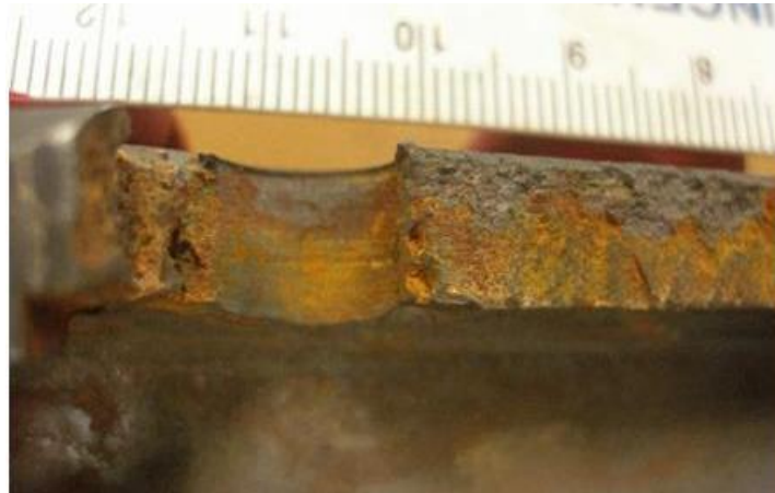
Figura 64 Superficie de la fractura primaria. Se observa una capa de productos de corrosión, el origen de la grieta en el barreno y deformación plástica en el fondo del mismo
