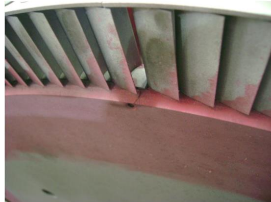
Figura 39 Fisuras en bandas y en el barreno del perno de seguro
