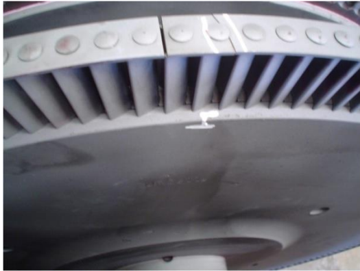
Figura 39 Fisuras en bandas y en el barreno del perno de seguro
