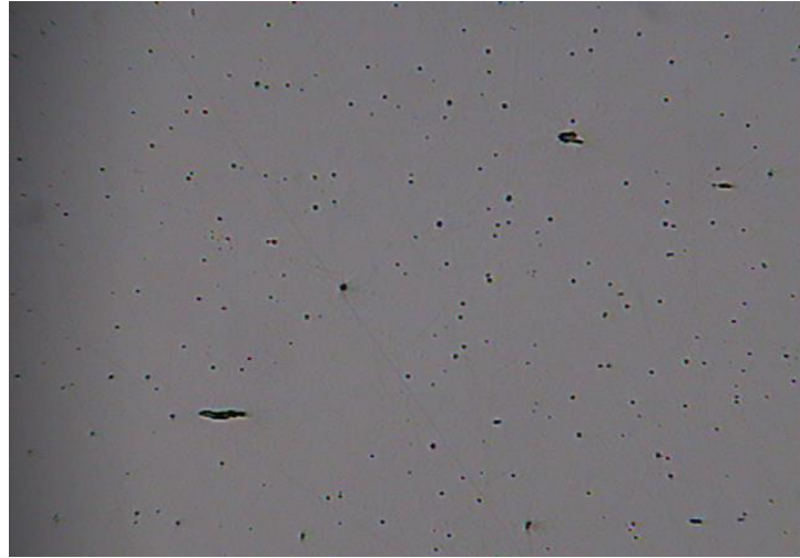
Figura 67 Se muestra a una escala 100X la superficie para análisis metalográfico antes de ser atacada. Se observa un alto nivel de inclusiones no metálicas
