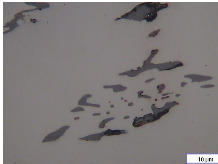
Figura 68 Se muestra a una escala 500X la región de inclusiones no metálicas, donde se pueden ver huecos generados a partir de ellas
