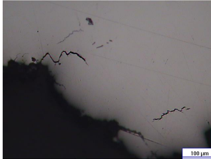
Figura 69 La imagen muestra a 200X la superficie para análisis metalográfico en la superficie de fractura. Se observan grietas secundarias existentes dentro del material y otra que crece a partir de la fractura
