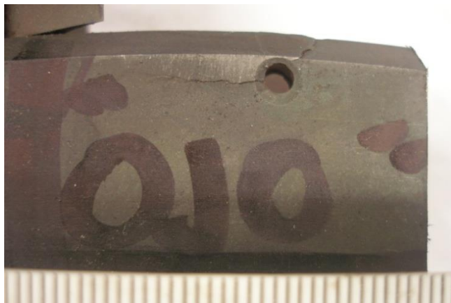
Figura 87 Se observan dos fracturas con origen en el barreno, además de una deformación plástica en el mismo
