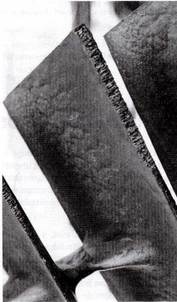
Figura 16 Erosión por impacto de humedad
