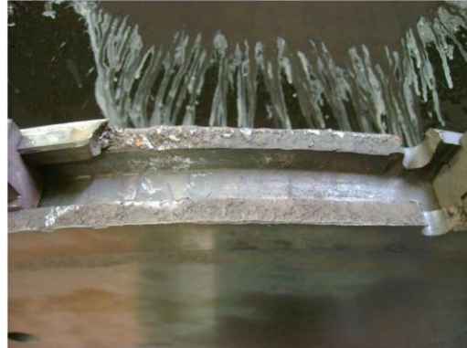
Figura 42 Detalle de la fractura en el disco
