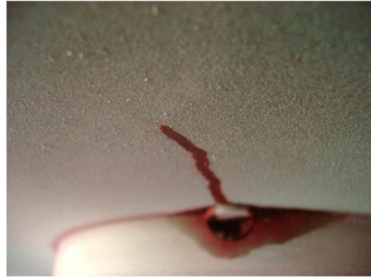
Figura 40 Fisura saliendo del cuñero
