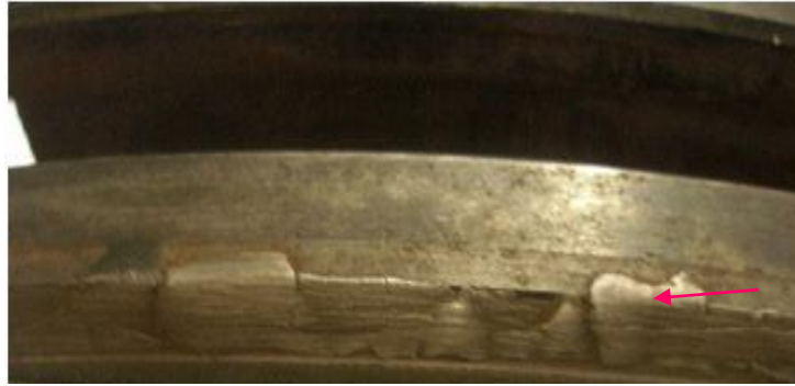
Figura 48 Marcas de un objeto metálico deformado fue encontrado en la muestra
