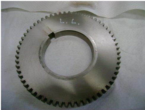
Figura 33 Engrane para sensor de velocidad con arrastre en dientes y fuerte deformación
