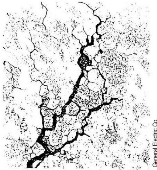
Figura 28 Sección transversal de un componente que ha fallado, debido a grietas intergranulares por SCC
