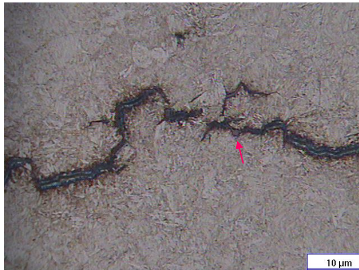
Figura 72 La micrografía muestra a 500X la microestructura en una de las grietas secundarias. Se observa en una zona la presencia de una inclusión no metálica
