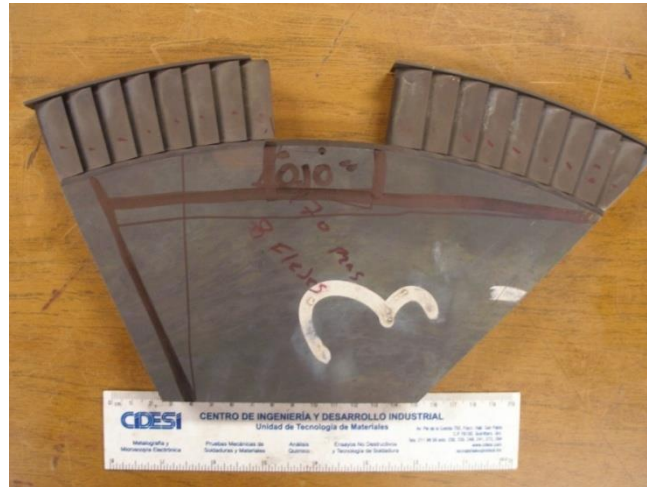
Figura 85 Muestra del disco de la turbina en preparación para el laboratorio
