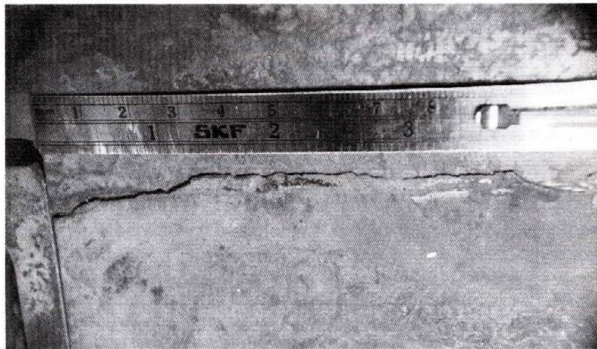
Figura 13 Grieta de fatiga por bajos ciclos sobre una carcasa de alta presión
