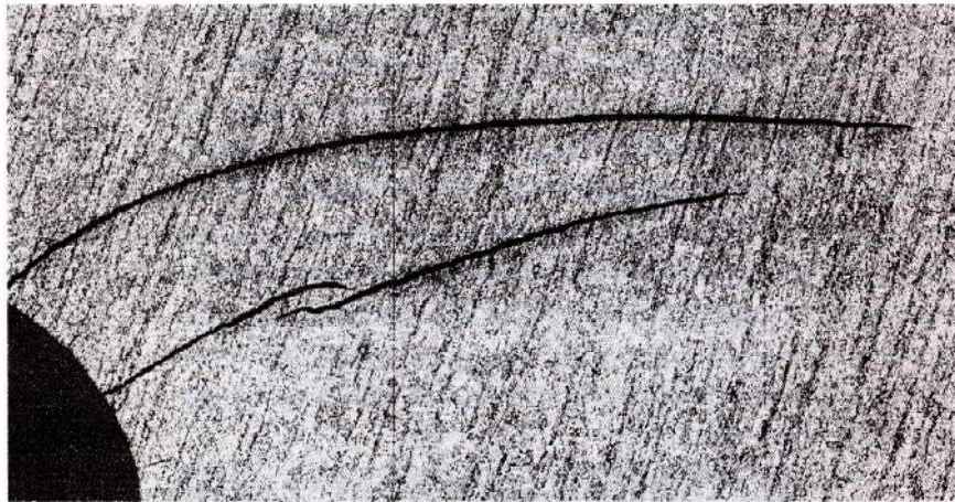
Figura 29 Grieta transgranular en la raíz de un álabe
