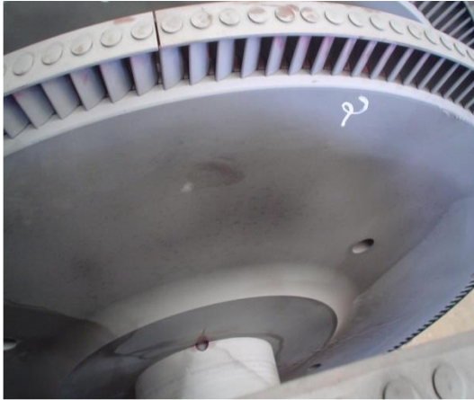
Figura 37 Fisura saliendo desde el cuñero de aproximadamente 2" de largo
