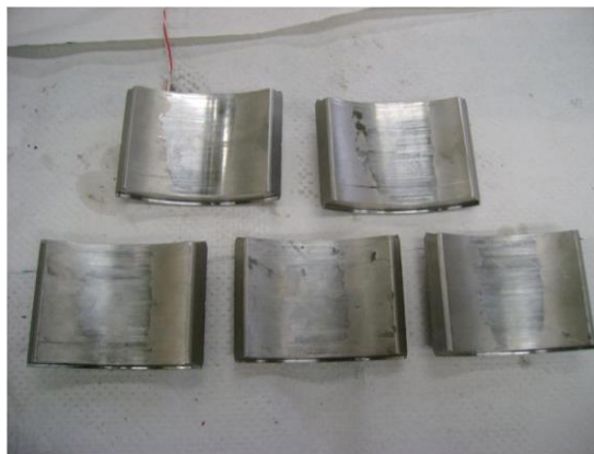
Figura 46 Chumaceras radiales, lado cople con desgaste por arrastre
