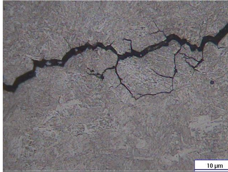
Figura 93 La micrografía muestra a 500X una grieta de tipo frágil en la cercanía de la grieta del radio de la canaleta
