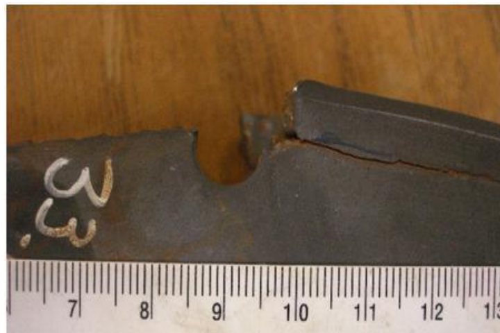
Figura 62 Se observa que el origen de la grieta se encuentra en el barreno
