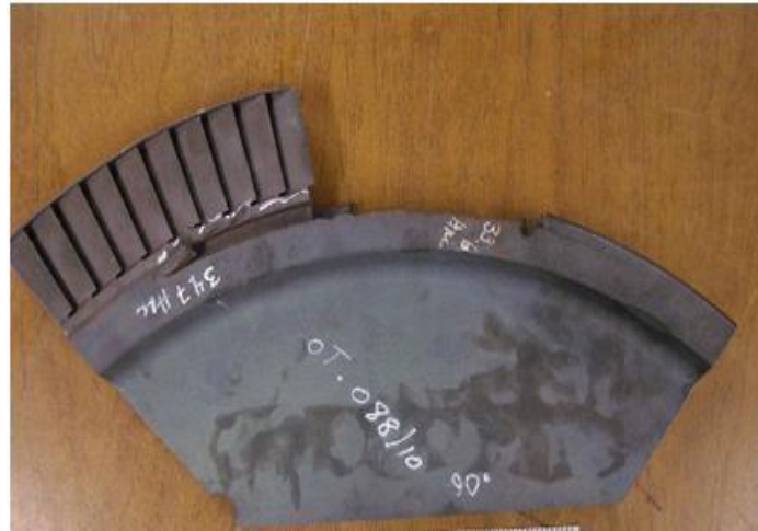
Figura 61 Muestra del disco de la turbina en preparación para el laboratorio
