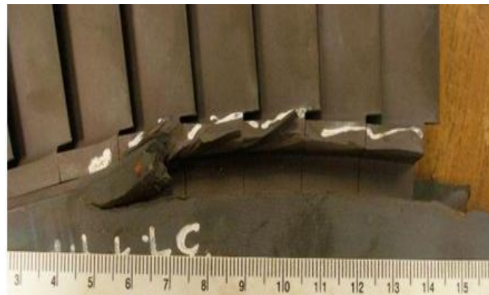
Figura 63 Se muestra el fin de la fractura. Se observa desgarramiento de la pestaña de la guía de los álabes con el disco
