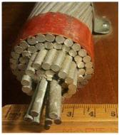
FIGURA 11. Cable reforzado con acero conductor de aluminio
