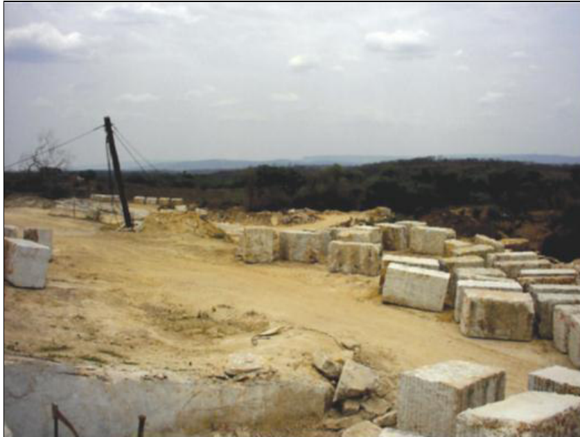
Figura 3.11 - Blocos estocados para comercialização no pátio da pedreira de granito na JQ3
