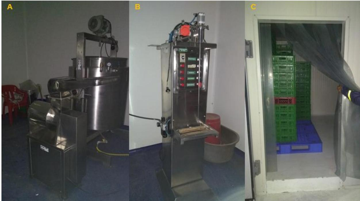
**Figura 23.** Marmita para realizar el proceso de pasteurización y descalcada (A), empacadora y selladora (B) y cuarto frío (C).
