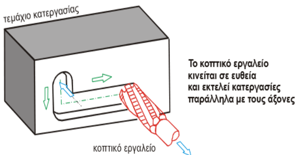
Σχήμα 5.3 : Πορεία κοπτικού εργαλείου σε σύστημα ελέγχου ευθύγραμμης κοπής.[5]
