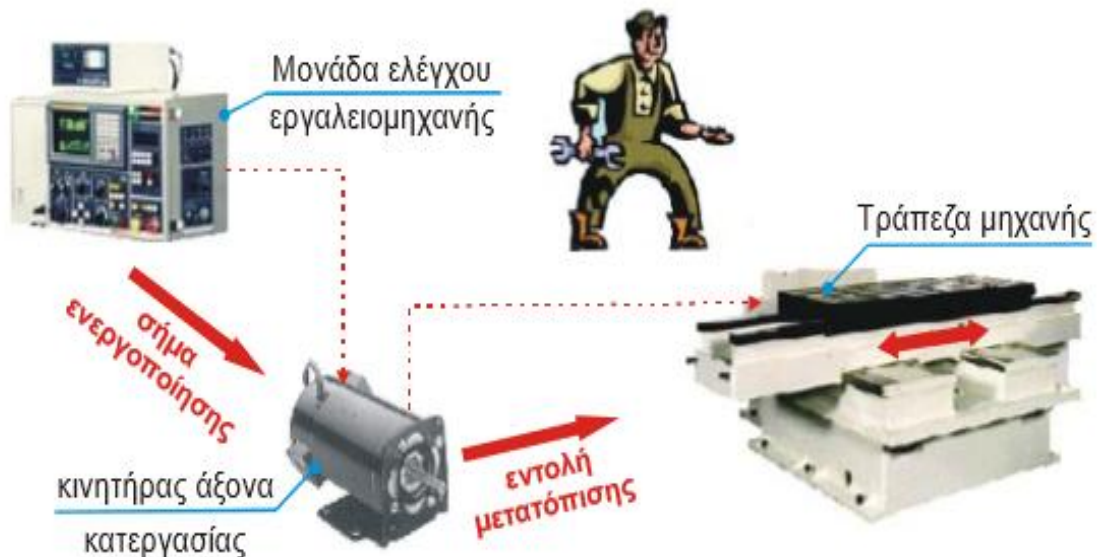
Σχήμα 4.3: Σύστημα ελέγχου ανοικτού βρόγχου για τον έλεγχο της μετατόπισης στους ολισθητήρες εργαλειομηχανών με ψηφιακή καθοδήγηση. [4]
