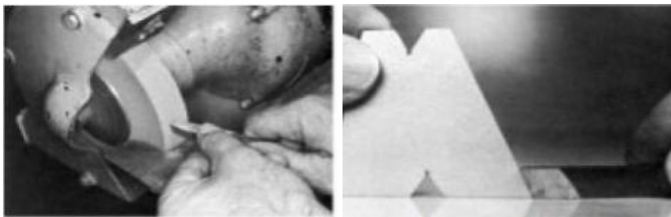
Εικόνα 7.2: Εκχόνδριση της δευτερεύουσας επιφάνειας ελευθερίας (αριστερά) και έλεγχος της γωνίας αποβλήτου (δεξιά). [1]
