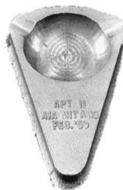
Σχήμα 2.2: Διάτρητη κάρτα και τασάκι κατασκευασμένο από την πρώτη ψηφιακά καθοδηγούμενη εργαλειομηχανή με τη βοήθεια της APT. [5]
