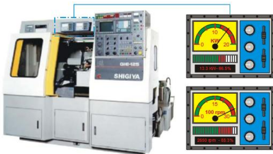
Σχήμα 4.2: Συστήματα ένδειξης της ισχύος, που απορροφά η κεντρική άτρακτος κοπής και της περιστροφικής της ταχύτητας. [5]
