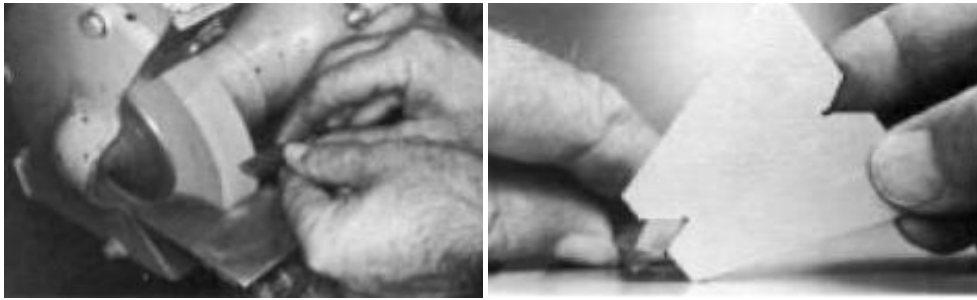
Εικόνα 7.3: Εκχόνδριση της επιφάνειας αποβλήτου (αριστερά) και έλεγχος της γωνίας σφήνα (δεξιά).[1]
