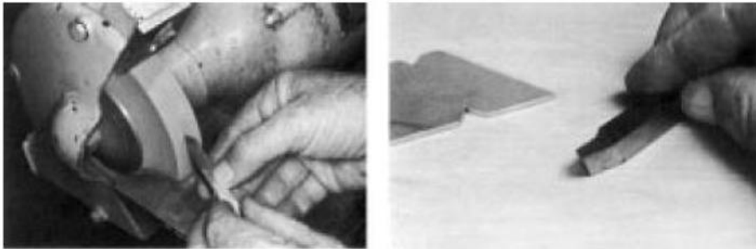
Εικόνα 7.4: Στρογγύλεμα της κύριας κοπτικής ακμής. [1]
