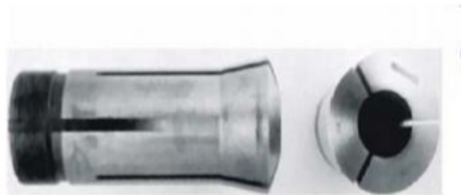
Σχήμα 1.26: Συγκράτηση με τσιμπίδα. [1]
