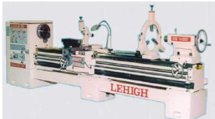
Σχήμα 1.16: Σύγχρονος τέρνος (παράλληλος κεντροφόρος) [1]
