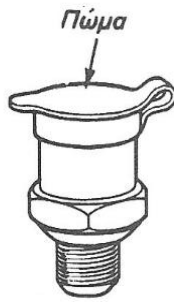
Σχήμα 1.27: Απλός λιπαντήρας ελεύθερης εκροής και λιπαντήρας θρυαλλίδας. [1]
