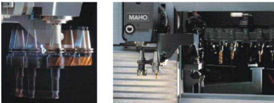
Εικόνα 6.11: Σύνθετοι μηχανισμοί αλλαγής κοπτικού εργαλείου με βραχίονα.[5]
