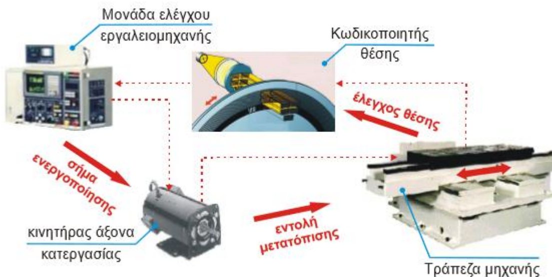
Σχήμα 4.4: Σύστημα ελέγχου κλειστού βρόγχου για τον έλεγχο της μετατόπισης στους ολισθητήρες εργαλειομηχανών με ψηφιακή καθοδήγηση. [5]
